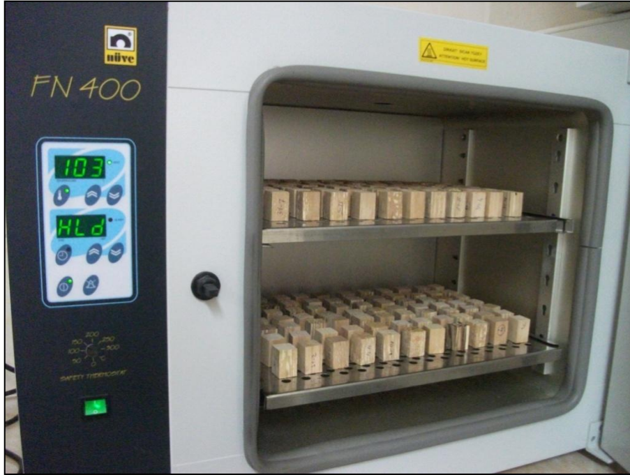
Şekil 14. Örnekler tam kuru hale gelinceye kadar fırında 103 \pm 2 \text{ }^\circ\text{C} de kurutulması
