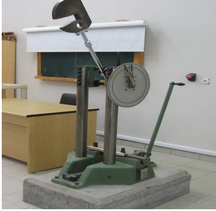
Şekil 18. Dinamik eğilme direnci deneyi
