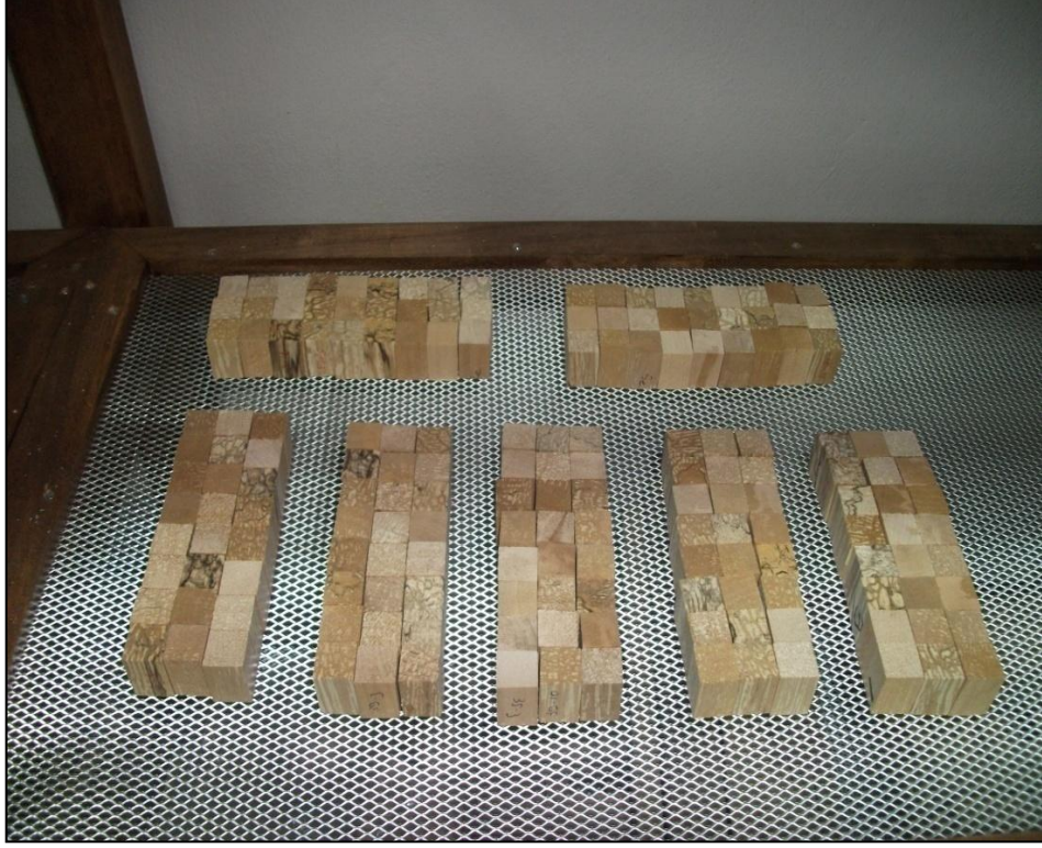
Şekil 13. Yoğunluk tayini için hazırlanan örneklerin iklimlendirme odasında % 12 nem oranına ininceye kadar bekletilmesi
