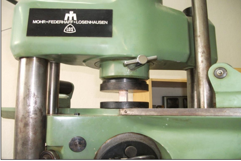
Şekil 15. Liflere paralel basınç direnci deneyi
