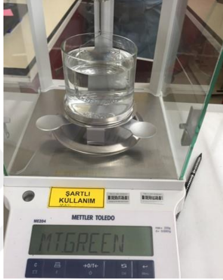
Şekil 24 Arşimet yöntemi deney düzeneği
