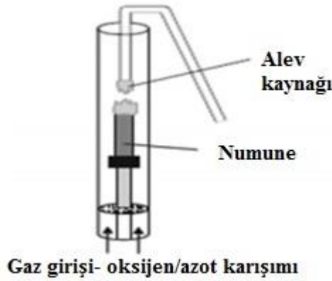
Şekil 32. LOI test düzeneği (Çelen, 2020).
