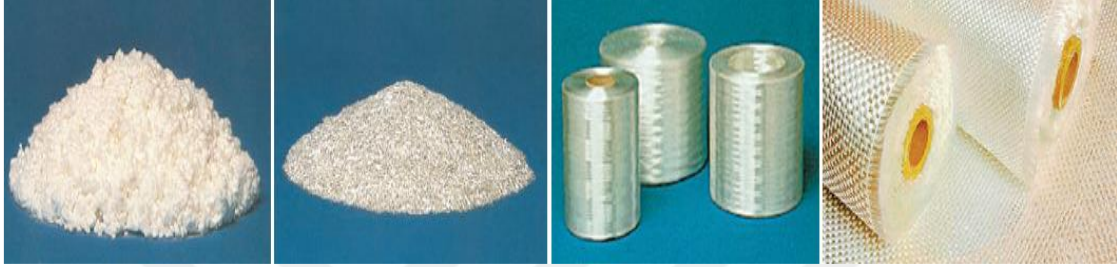
Şekil 12. Cam takviye örnekleri: öğütülmüş, kırılmış, fitil ve dokuma (Sönmez, 2009).
