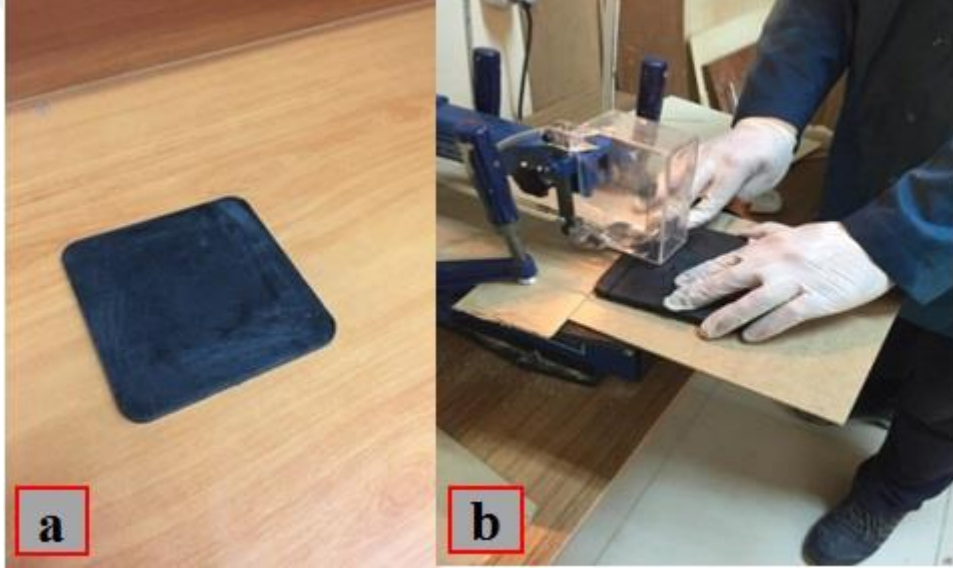
Şekil 22. (a) Kalıptan çıkarılan kompozit levha (b) Deneyler için kompozit levhadan standartlara göre numune alınması
