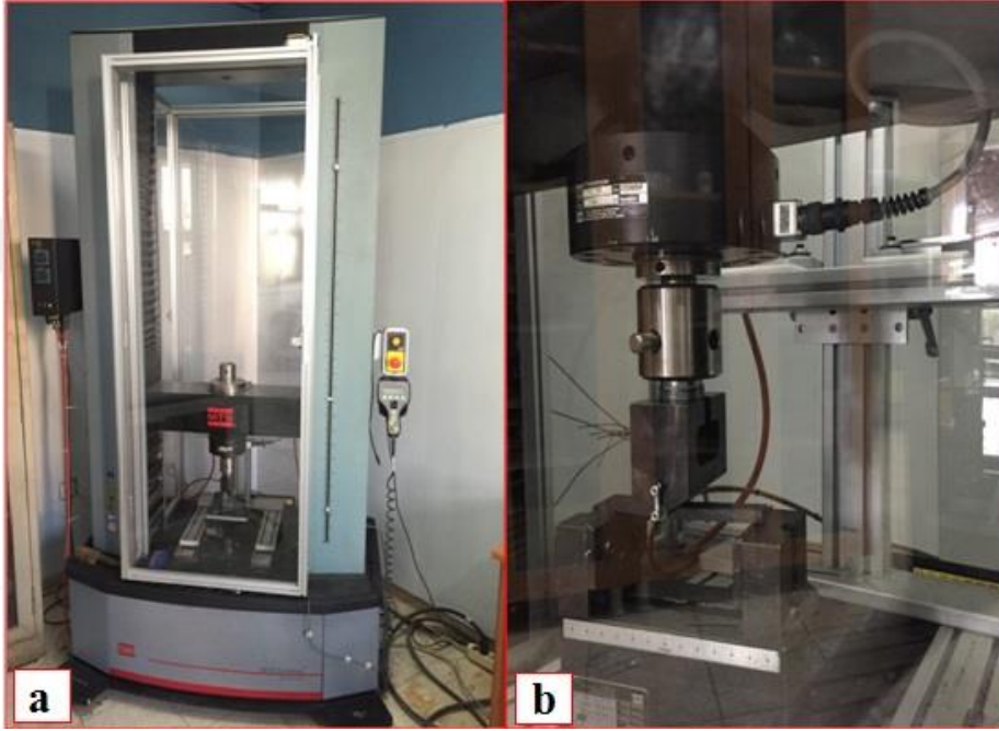
Şekil 29. Eğme testi cihazı görüntüsü ve deney anı
