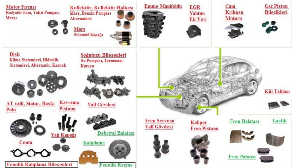
Şekil 11. Fenolik reçinelerin otomotiv uygulamaları (Hirano ve Asami, 2012).
