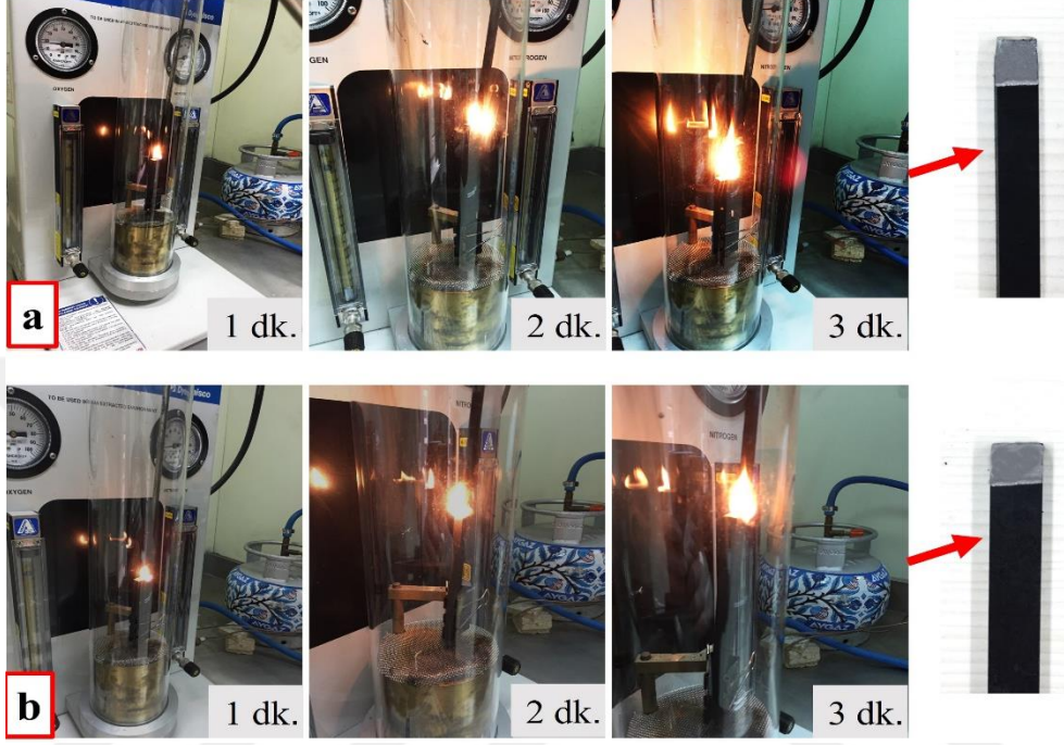
Şekil 48. (a) N3 ve (b) N5 hibrit kompozit numunelerinin yanma davranışı
