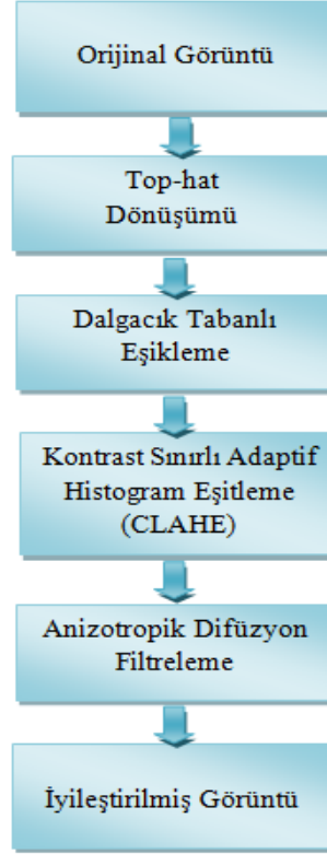
Şekil 2.10. Kitle tespiti için geliştirilen iyileştirme algoritması
