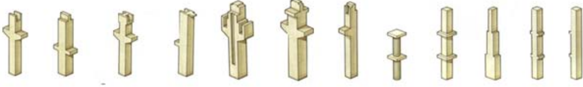
Şekil 1.2. Prefabrik kolonlara ait çeşitli örnekler
