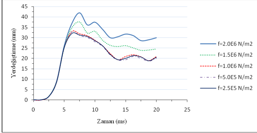
Şekil 2.26. PANEL-A modelinde farklı patlama yüklemeleri altında panel merkezinde oluşan yerdeğişimler
