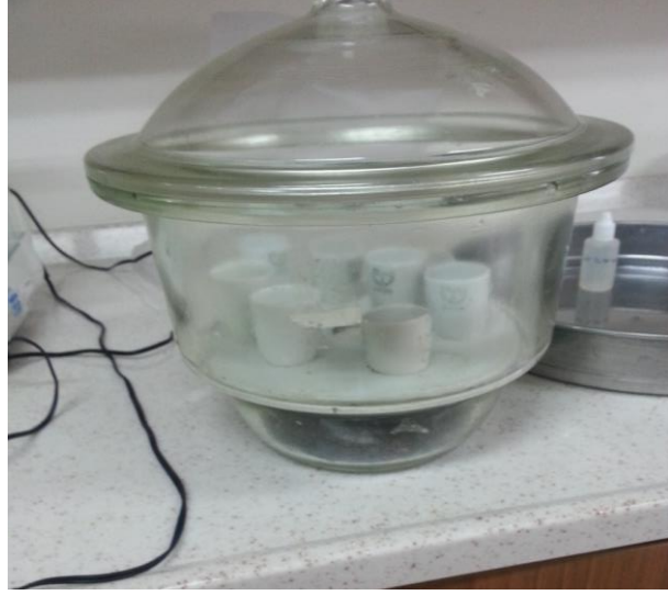
Şekil 60. Desikatör yardımıyla soğutma işlemi
