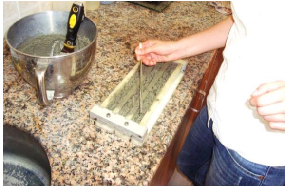
Şekil 52. Harcın şişlenerek sıkıştırılması (birinci katman)
