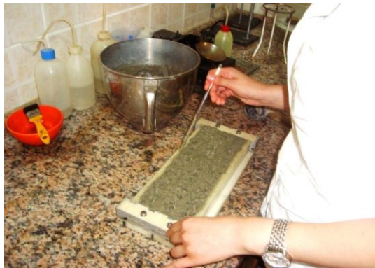
Şekil 53. Harcın şişlenerek sıkıştırılması (ikinci katman)
