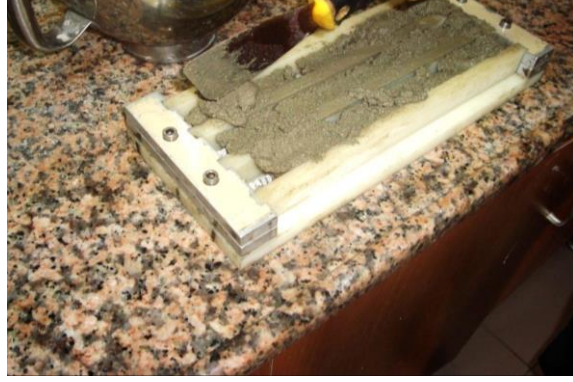
Şekil 51. Hazırlanan harcın kalıba yerleştirilmesi
