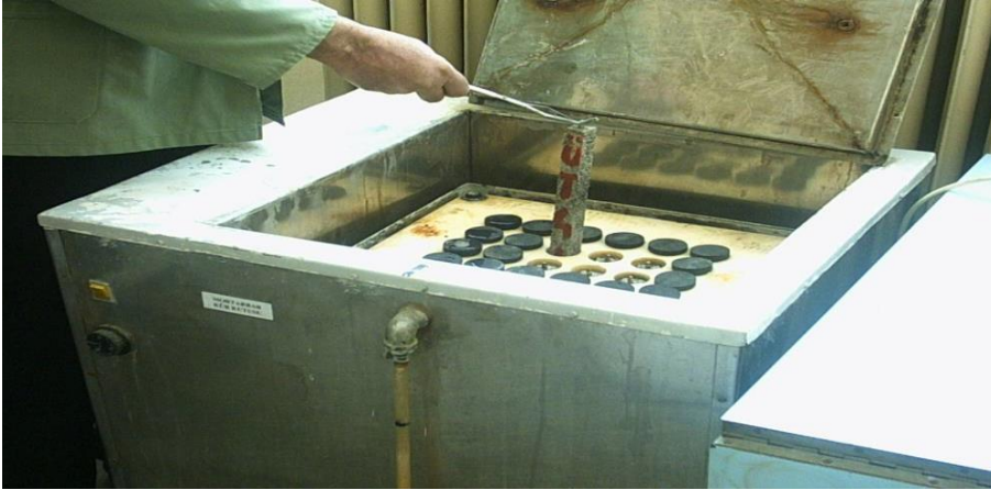
Şekil 26. Termostat’lı kür tankı
