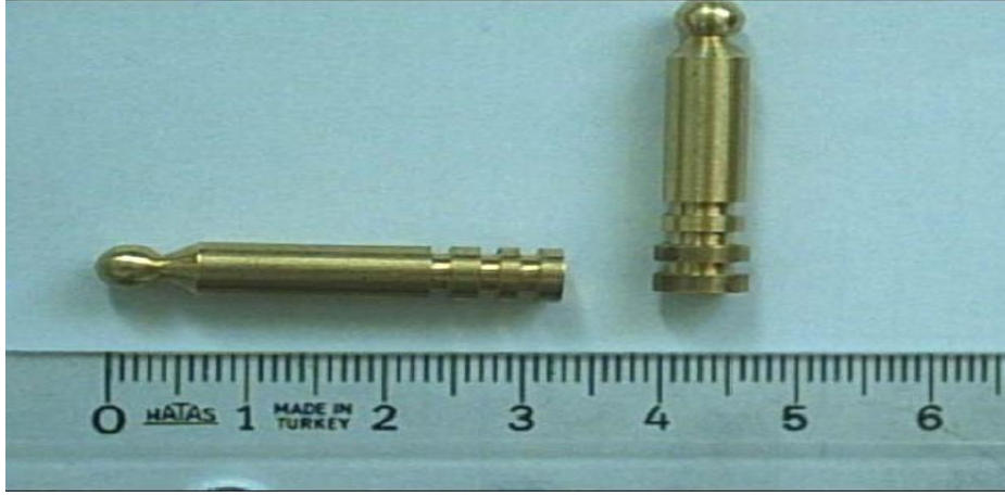
Şekil 23. Harç çubuklarının uçlarına yerleştirilen pim
