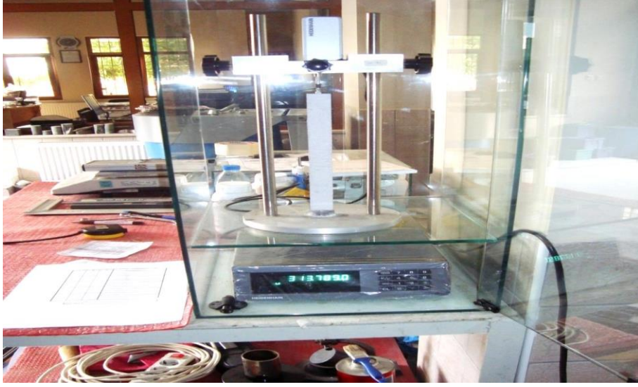
Şekil 56. Harç çubuklarının boy değişimlerinin ölçümünün yapılması
