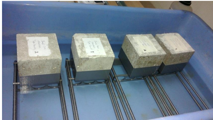
Şekil 16. Kılcallık deney düzeneği
