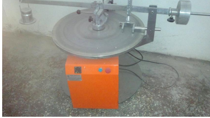
Şekil 12. Böhme yüzey aşındırıcı test cihazı
