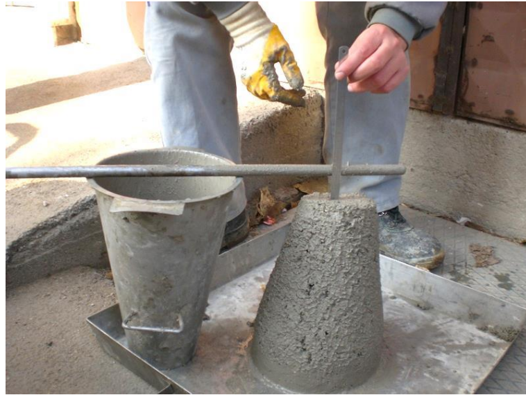
Şekil 15. Çökme (abrams huni) deneyi
