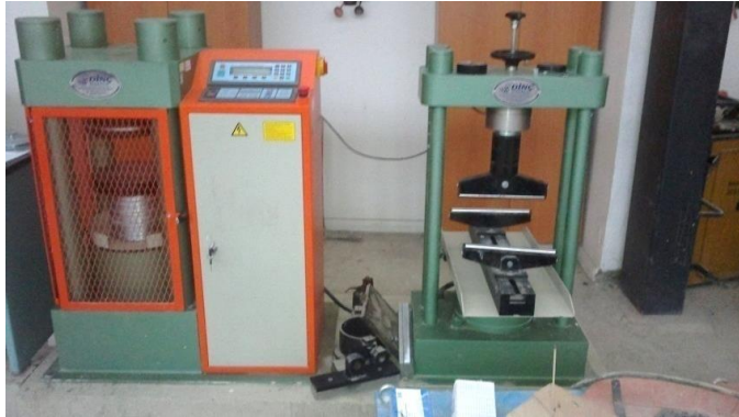
Şekil 11. Beton test presi
