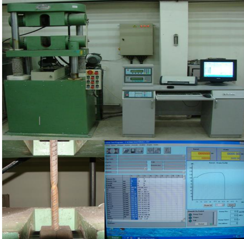
Şekil 48. 600 kN kapasiteli universal deney aleti.
