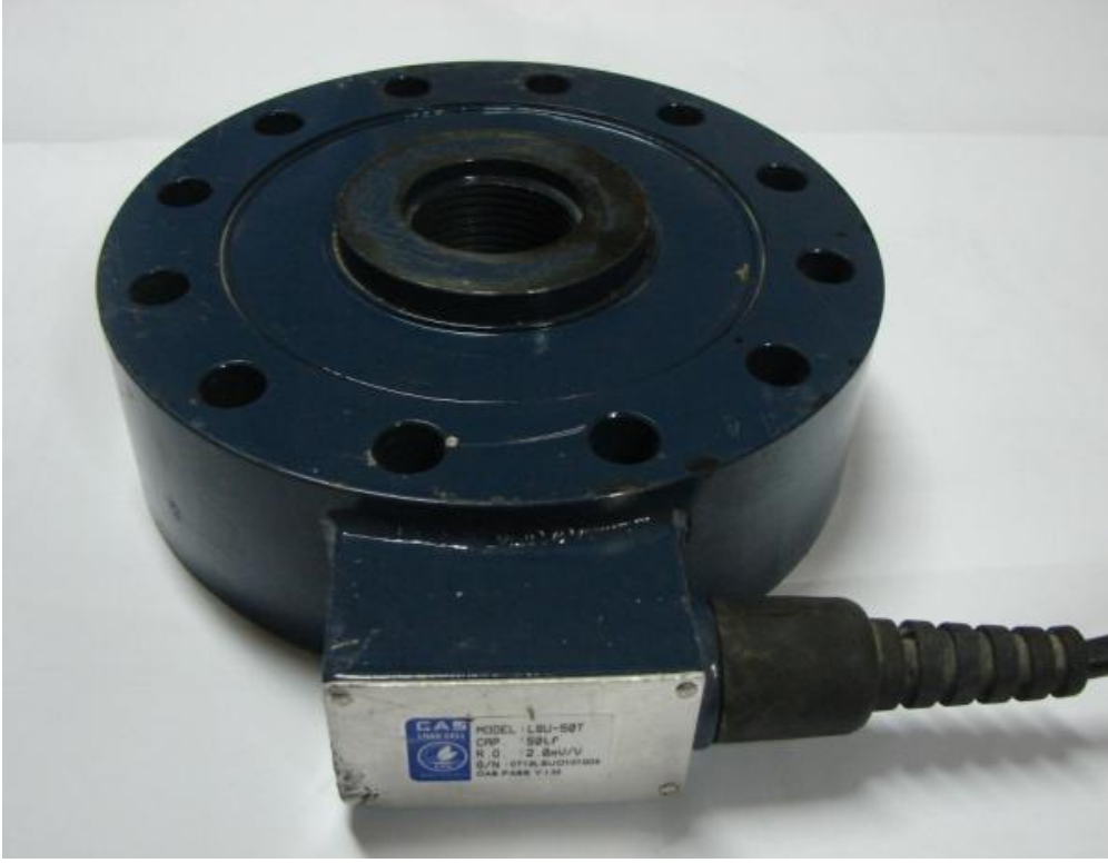
Şekil 69. Hidrolik silindirin ucuna yerleştirilen yük hücresi (Loadcell).
