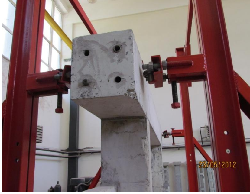
Şekil 66. Kiriş içinde açılmış 30 mm çapındaki 4 adet kanal.
