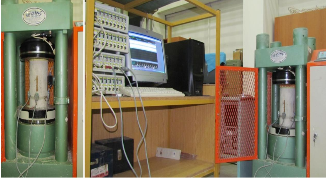
Şekil 62. Standart silindir numuneler üzerinde yapılan basınç deneyi.
