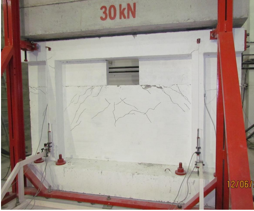
Şekil 114. Mevcut perde duvarda oluşan çatlaklar.
