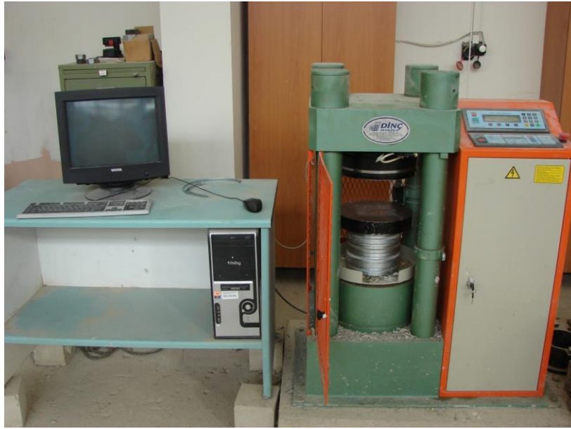
Şekil 52. Basınç deneylerinde kullanılan 2500 kN kapasiteli deney aleti.
