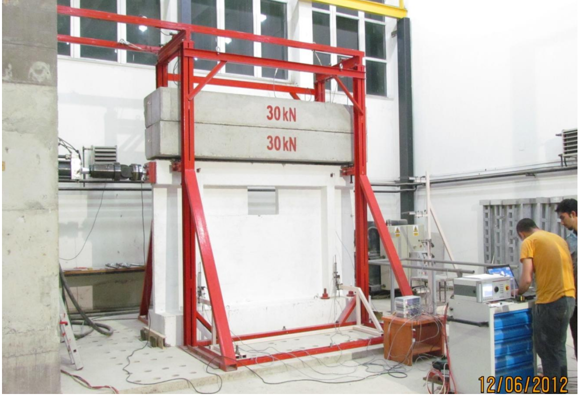
Şekil 112. Bant pencere genişliği 0.25 ve her iki tarafta kanat dolgu duvar genişliği 0.375L olan DE-4 numaralı deney elemanı.
