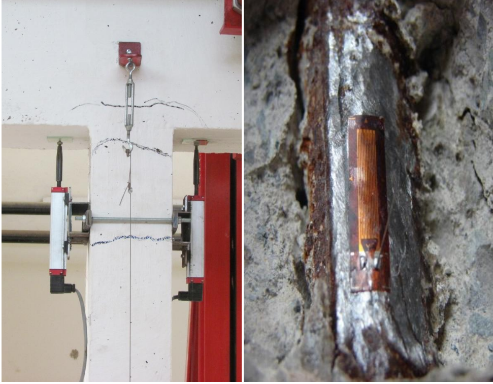
Şekil 70. Deneylerde kullanılan LPDT' ler ve donatı yüzeyine yapıştırılmış şekildeğiştirme ölçeri (Strain gauge).
