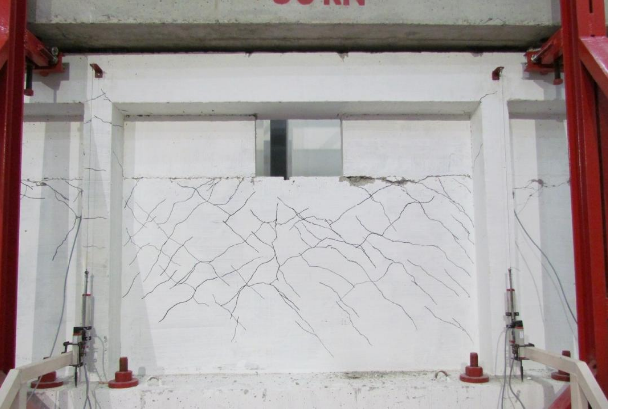
Şekil 116. Test sonrasındaki hasar durumu.
