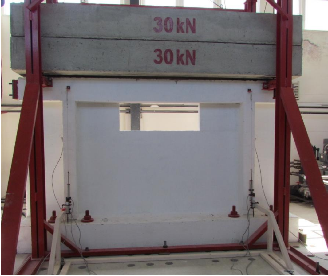
Şekil 102. 0.25H bant pencere ve 0.25L kanat dolgu duvarlı DE-3 numaralı deney elemanı
