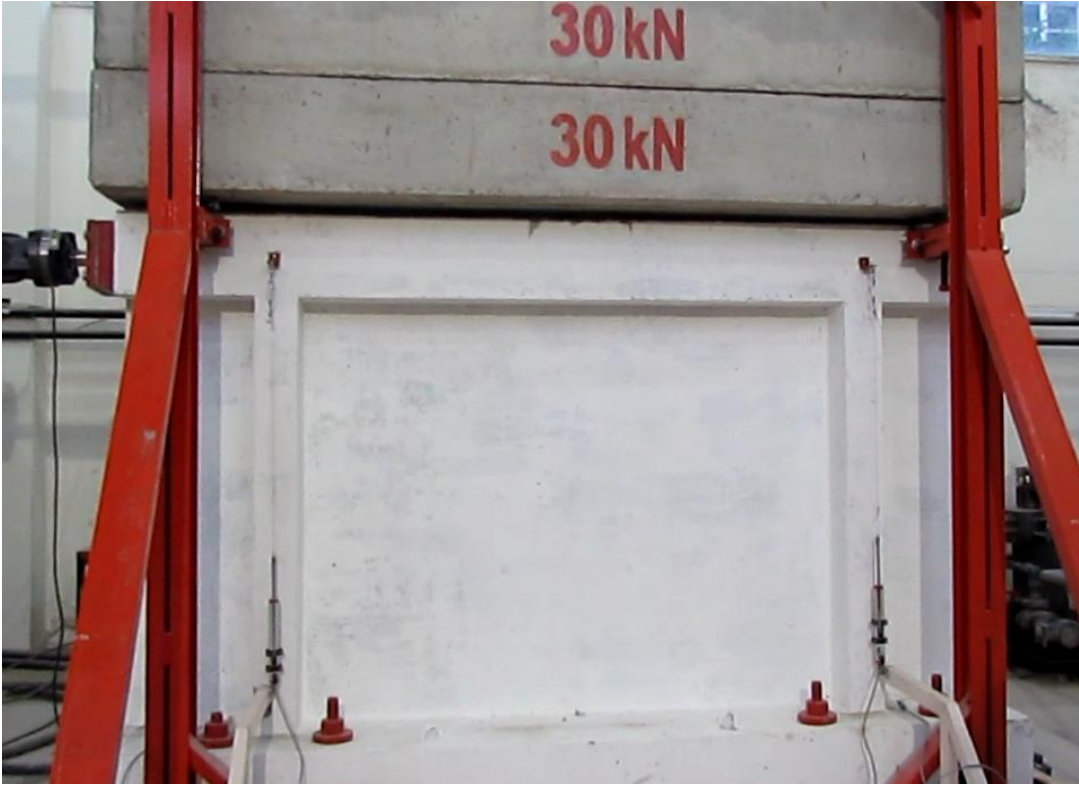
Şekil 121. Açıklığın tamamı betonarme perde kullanılarak üretilen DE-5 numaralı deney elemanı.
