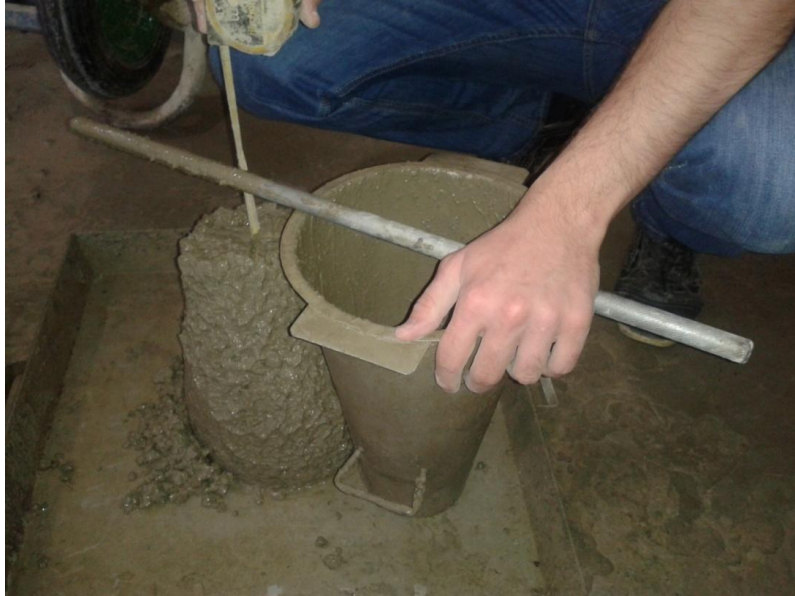
Şekil 2.6. Çökme değerinin ölçülmesi
