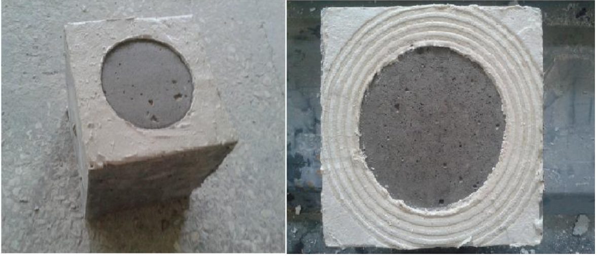
Şekil 2.11. Basınçlı su tatbik edilecek yüzeylerin deney öncesi (sol) ve deney sonrası (sağ) görünümü
