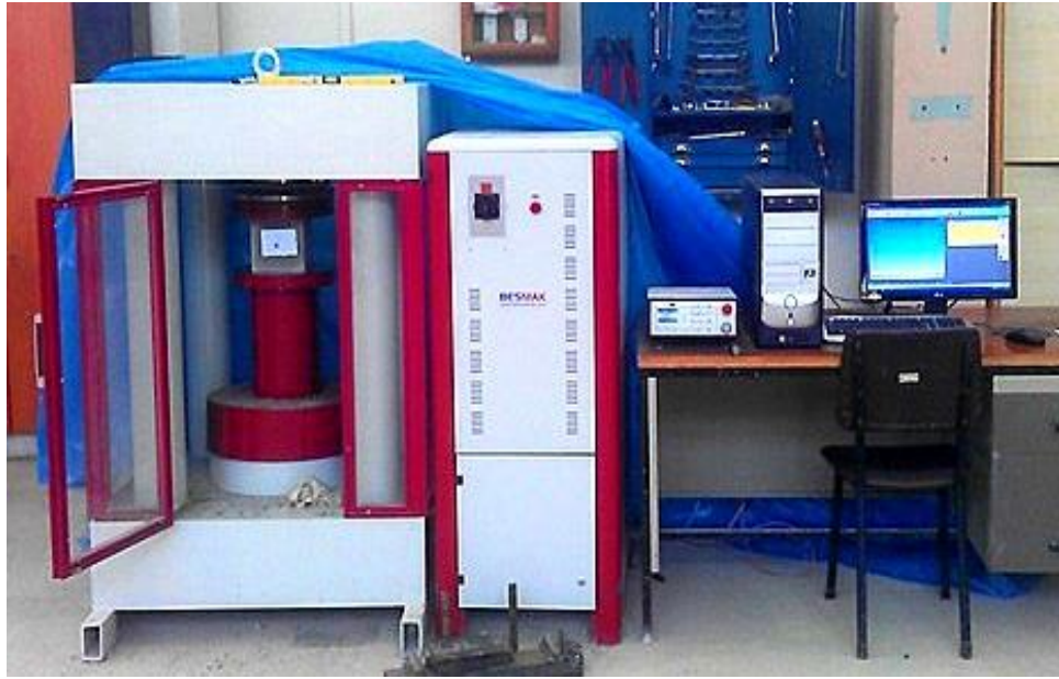
Şekil 2.8. Merkezi basınç deney anından bir görünüm
