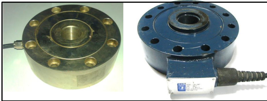
Şekil 2.15. Deney sisteminde kullanılan elektronik yük hücreleri
