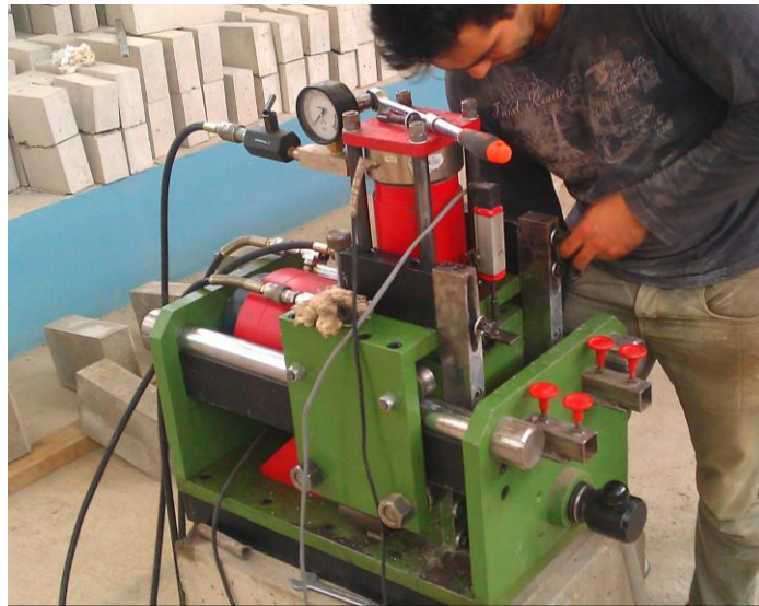
Şekil 2.22. Gezer aksenal yük çerçevesinin üst yuvaya sabitlenmesi
