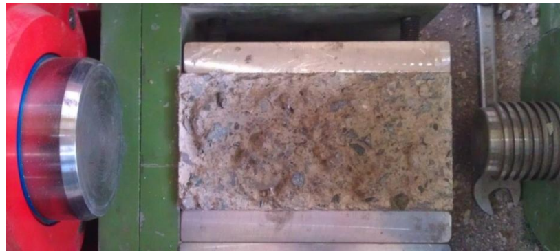
Şekil 2.24. Deney sonrasında bir numunenin kesilmiş yüzeyinin deney aletindeki görünümü
