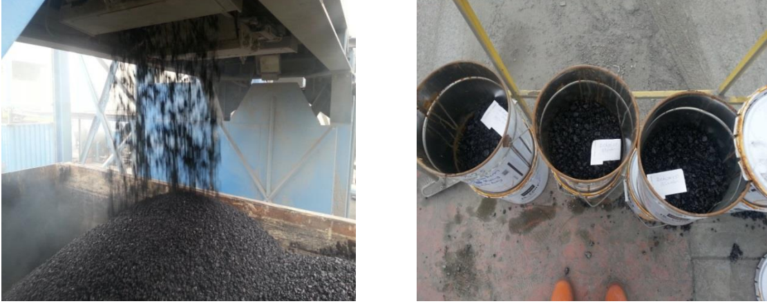
Şekil 2.5. Plent altından karışım numunelerinin alınması ve kaplara doldurulması
