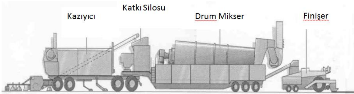
Şekil 1.22. Yerinde sıcak geri dönüşüm.[5]
