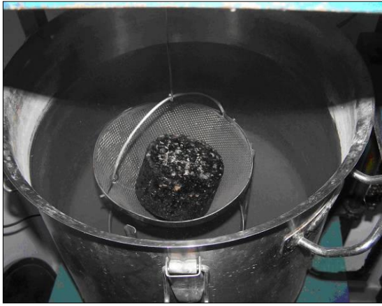
Şekil 2.13. Briketlerin havada ve suda tartılması
