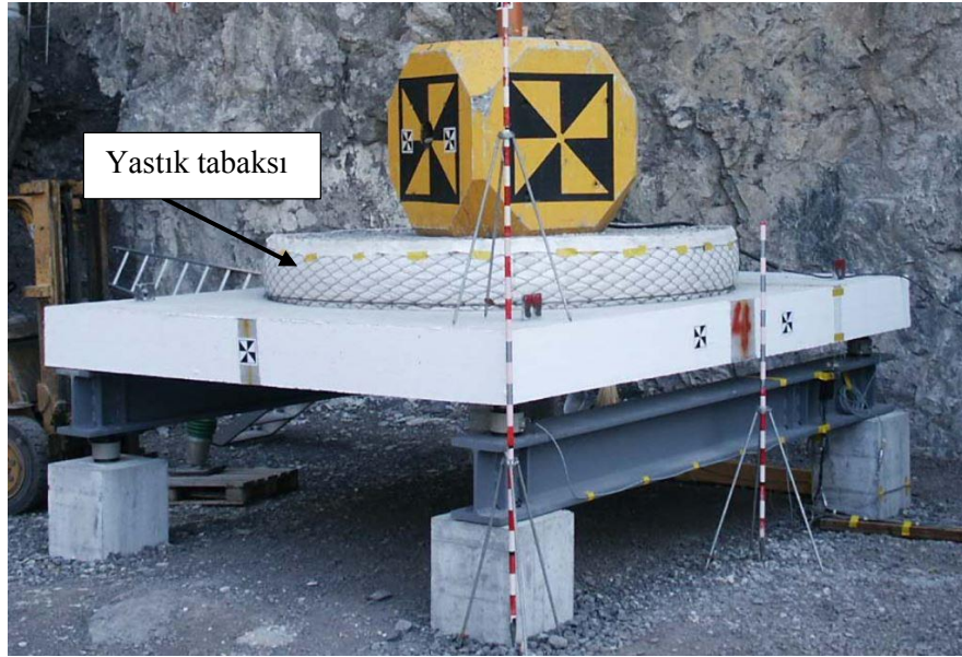
řekil 1.33. Darbe y¼k¼n¼ oluřturmak için hazırlanan test d¼zeneęi (Schellenberg vd., 2008)
