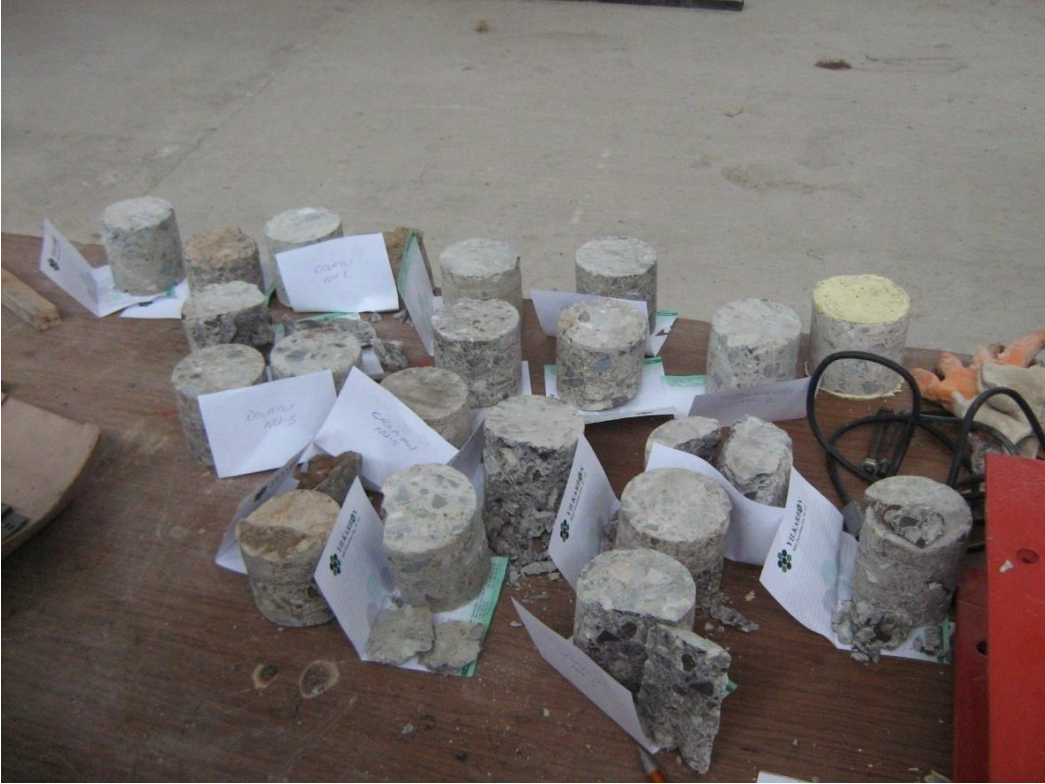
Şekil 3.9. Kırılan Numuneler toplu olarak görülmektedir. Basınç dayanımlarına ulaşmış olmalarına rağmen birçoğu dağılmamıştır.
