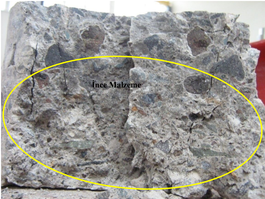
Şekil 3.8. Granülometre eksikliği ve çimento hamurunun kaliteli olmaması net şekilde anlaşılmaktadır. İşaretli kısımda ince agrega dikkat çekmektedir.
