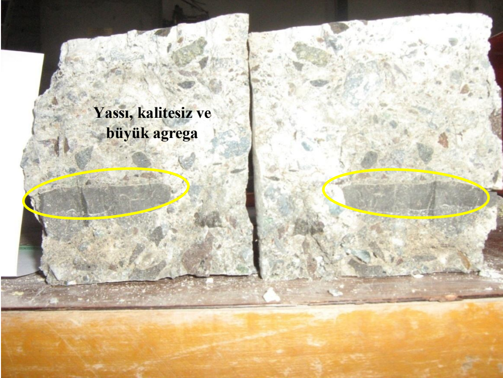
Şekil 3.6. Kırılan yüzeyde zayıf gradasyon ve yassı agrega görülmektedir.
