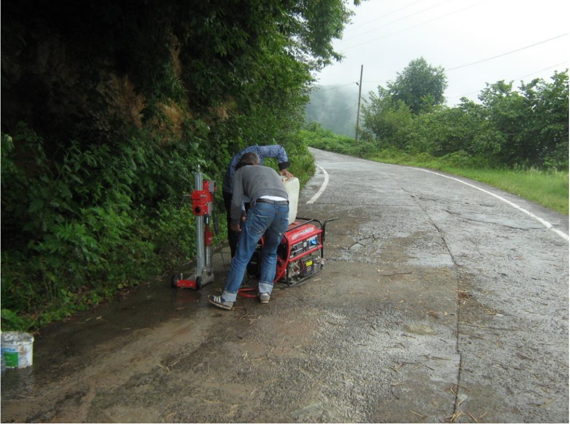
Şekil 2.8. Dolaylı Çağlayan arası kaplama kenarından numune alımı.
