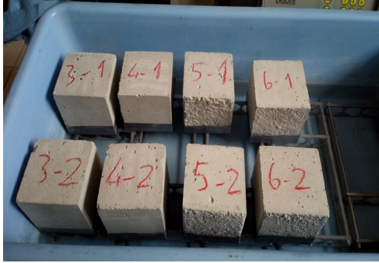
Şekil 2.9. Kılçak su emme (kılcallık) deney düzeneği
