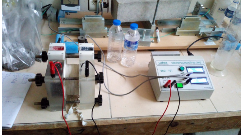
Şekil 2.12. Deneye hazır haldeki hızlı klorür deney düzeneği
