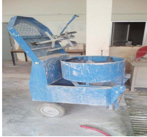
Şekil 2.3. 45 lt kapasiteli pan tipi betoniyer
