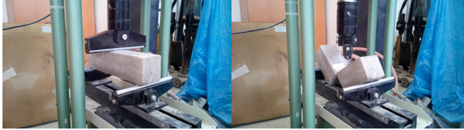
Şekil 2.7. 3 nokta eğilme testi ve kırılan bir numune
