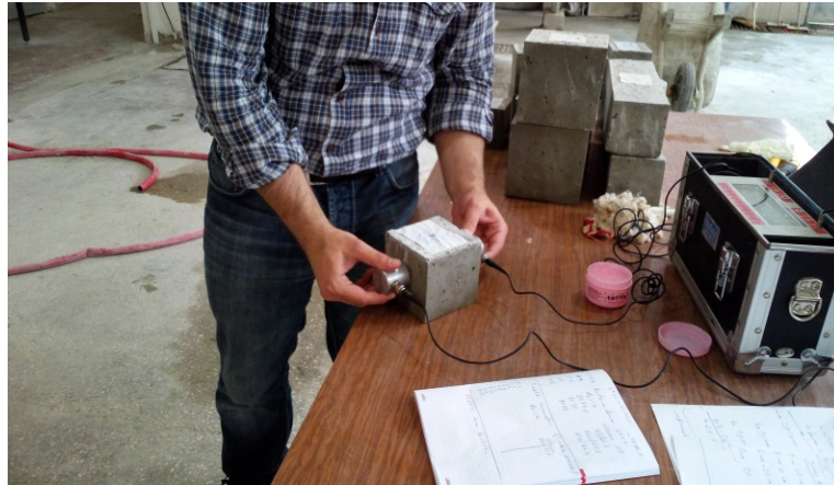
Şekil 2.15. Numunelerin ultrases geçiş hızlarının ölçümü
