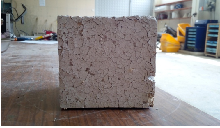
Şekil 2.17. 800°C’de 1 saat bekletilen bir numunenin görünüşü
