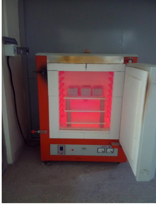
Şekil 2.16. 800°C'de 1 saat bekletilen beton numuneler
