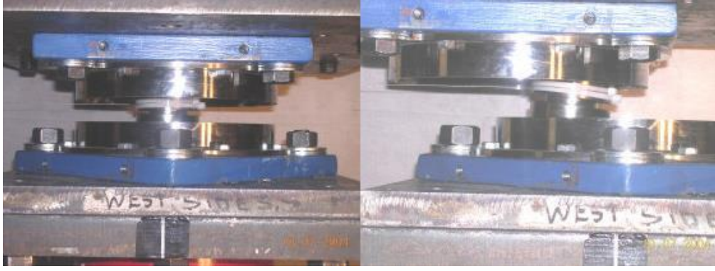
Şekil 1.7. Sürtünmeli sarkaç sisteminin maksimum yerdeğiştirmesi (Constantinou, 2004).
