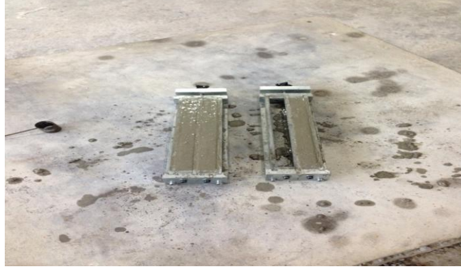
Şekil 30. Hazırlanan harcın kalıplara yerleştirilmesi (İkinci tabaka)
