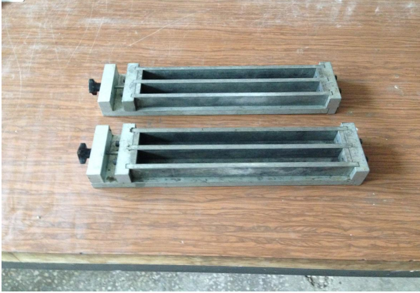
Şekil 22. Deneyde kullanılan harç çubuğu kalıpları
