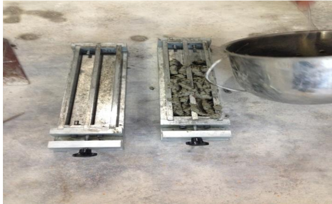
Şekil 29. Hazırlanan harcın kalıplara yerleştirilmesi (Birinci tabaka)
