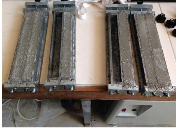
Şekil 31. Harç çubukların kalıptan çıkarılmadan önceki durumu
