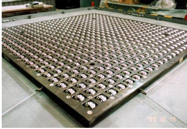
Şekil 1.5. Çelik bilyalı izolatör
