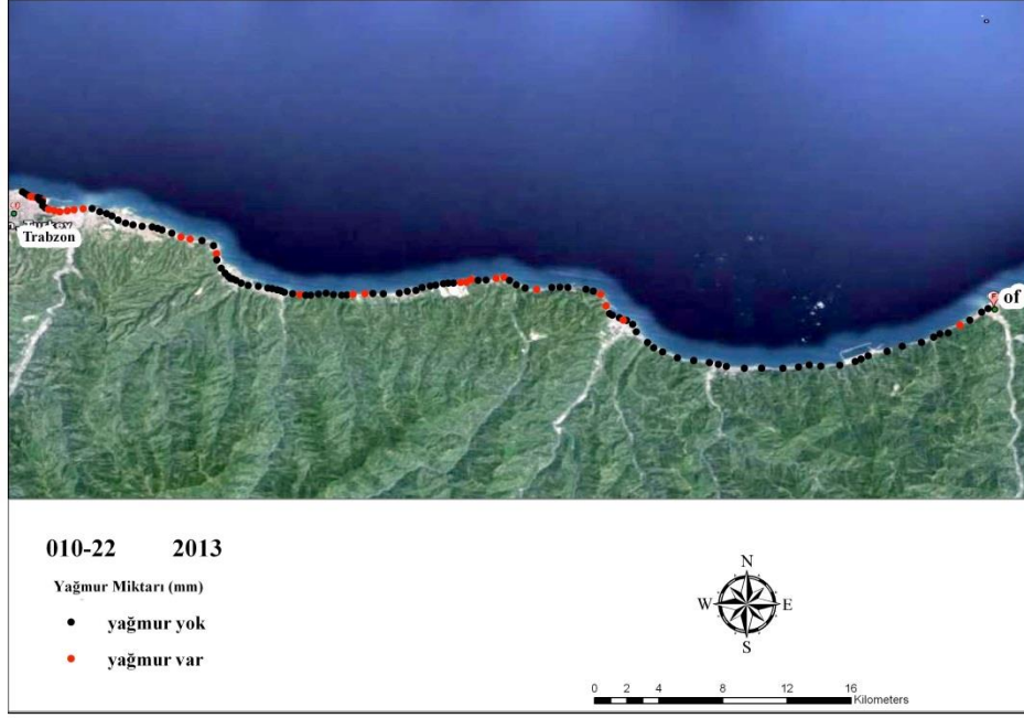
Şekil 93. Trabzon ilinin 2013 yılında 010-22 kesim nolu yolunda yağmur miktarına göre meydana gelen kaza haritası
