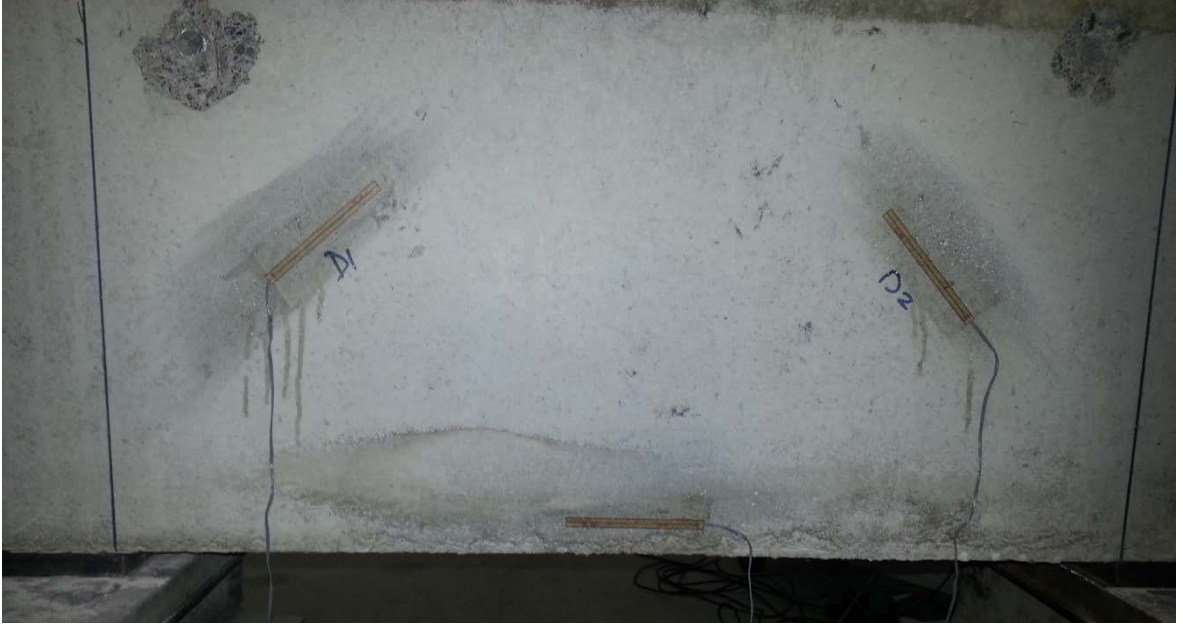
Şekil 51. Beton yüzeyine yapıřtırılmıř birim şekildeğiřtirme ölçeri (Strain Gauge)
