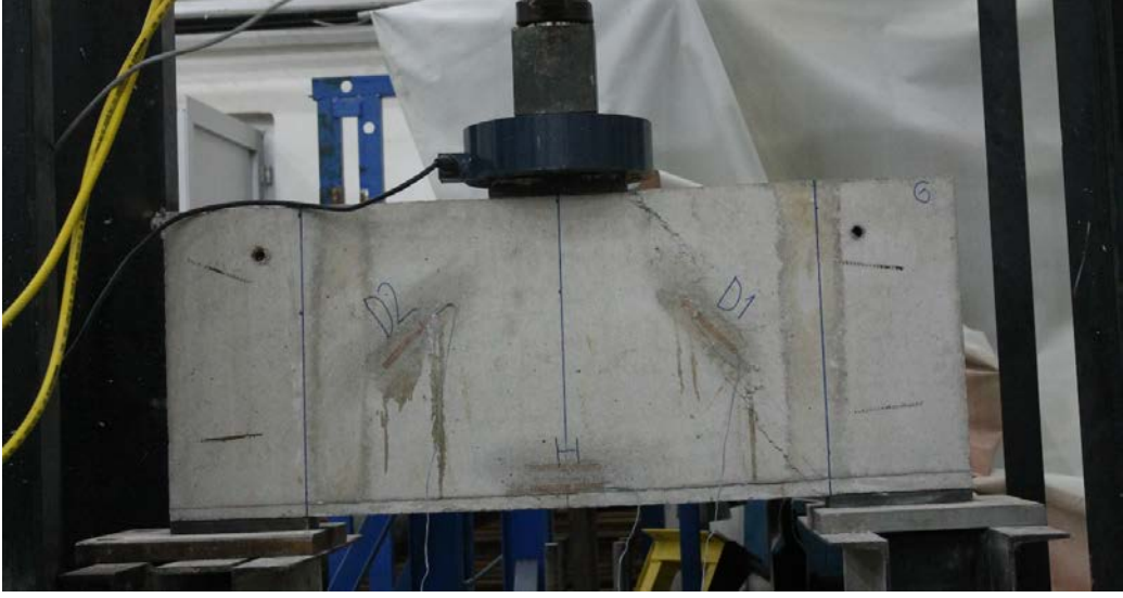
Şekil 85. DE-4 numaralı deney elemanının anlık çatlak oluşumu.
