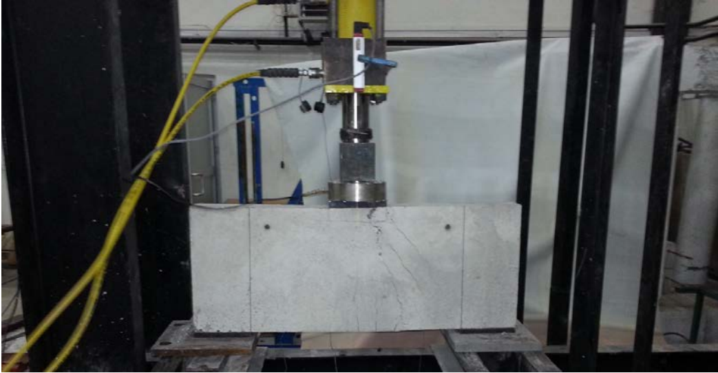
Şekil 69. DE-2 numaralı deney elemanının anlık çatlak oluşumu
