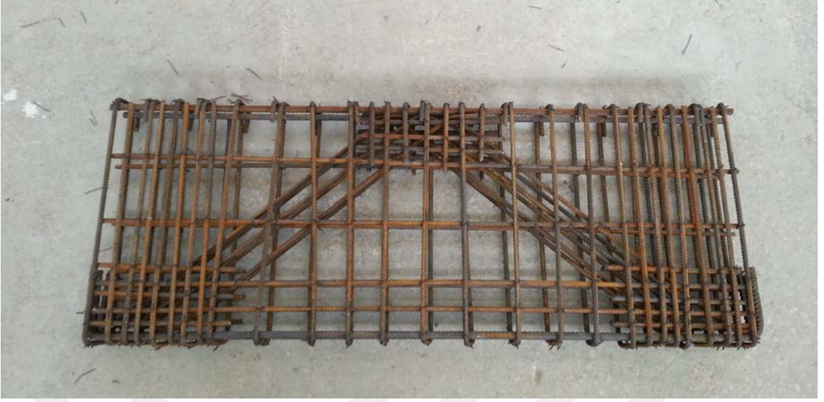
Şekil 38. DE-2 numaralı deney elemanı donatı düzeni
