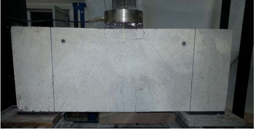
Şekil 68. DE-2 numaralı deney elemanının eğilme ve basınç bölgelerinde çatlak oluşumu
