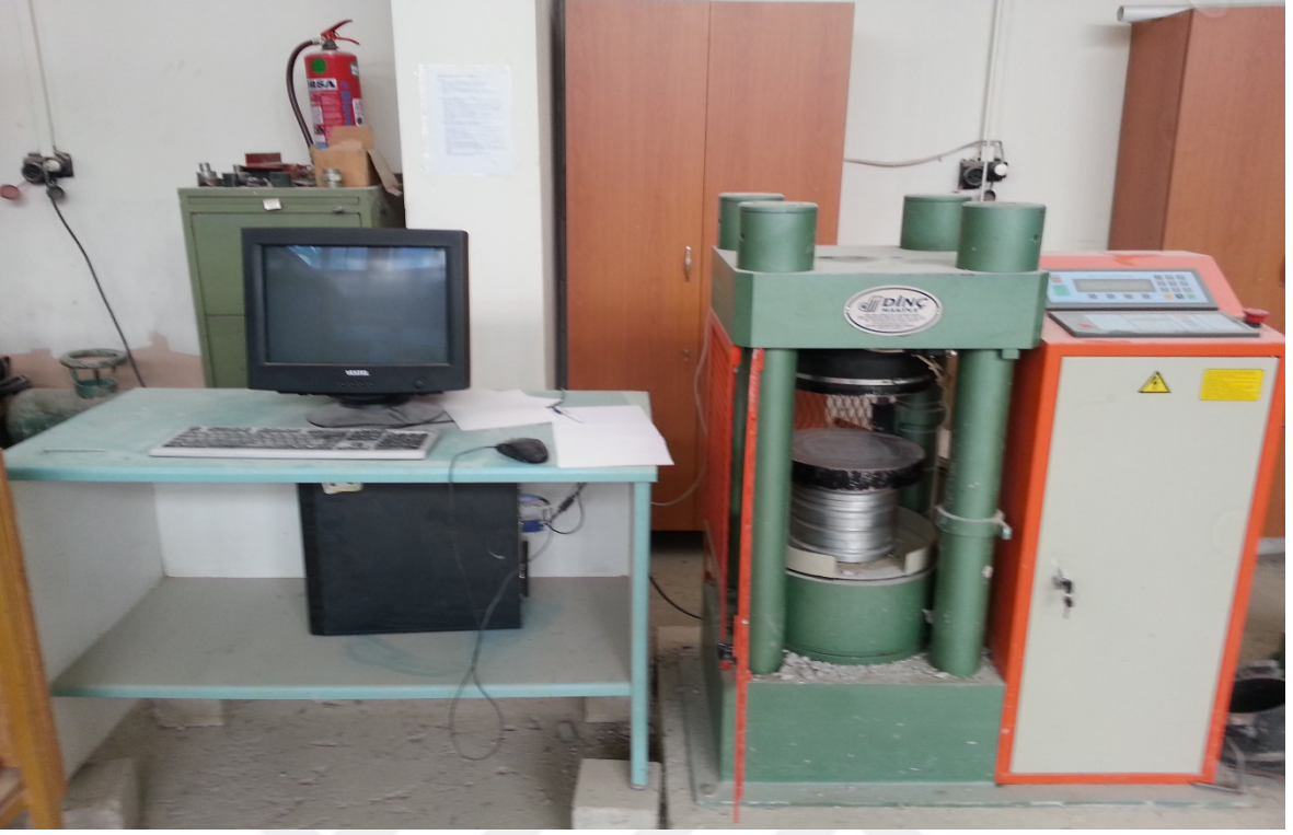
Şekil 42. 2500 kN kapasiteli basınç deneylerinde kullanılan deney aleti
