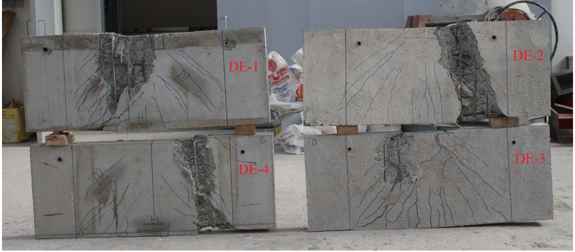
Şekil 92. Deney elemanlarına ait nihai durumda kırılma şekilleri
