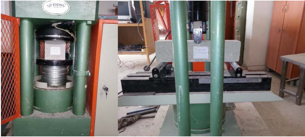
Şekil 46. Şahit numuneler üzerinde yapılan basınç ve eğilme deneyi
