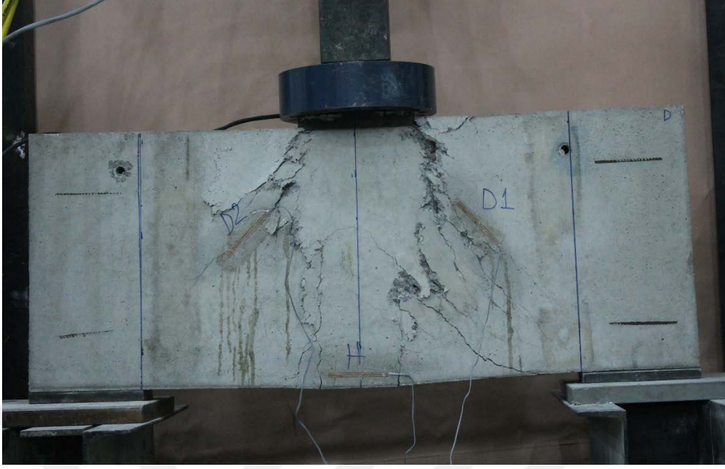
Şekil 79. DE-3 numaralı deney elemanına ait nihai durumdaki çatlaklar
