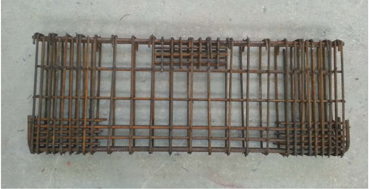
Şekil 37. DE-1 numaralı deney elemanı donatı düzeni
