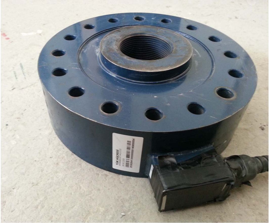
Şekil 49. 1000 kN yük ölçebilen, yük hücresi (Loadcell)
