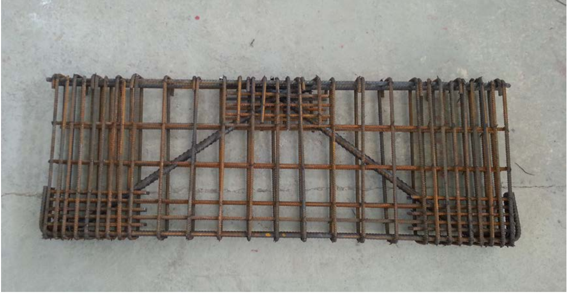
Şekil 39. DE-3 numaralı deney elemanı donatı düzeni
