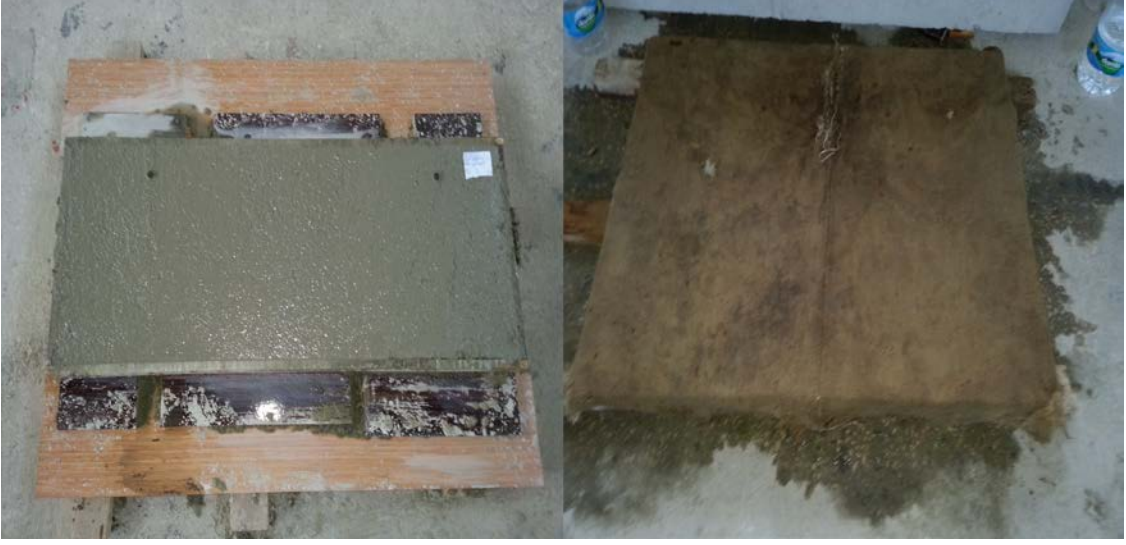
Şekil 45. Deney elemanın beton dökülmüş hali ve kür uygulamasından görünüm
