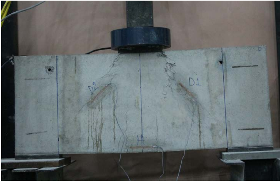
Şekil 78. DE-3 numaralı deney elemanında çatlakları oluşumuna ait bir görünüm
