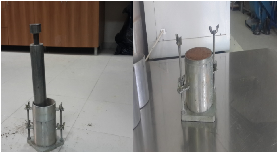
Şekil 2.12. Standart kompaksiyon deney seti
