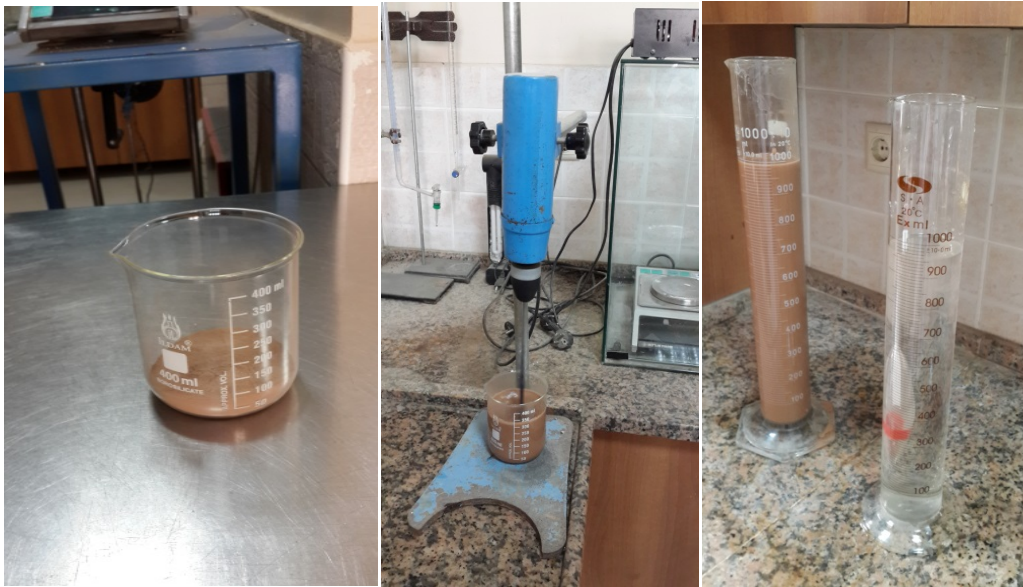
Şekil 2.7. Hidrometre deney görselleri
