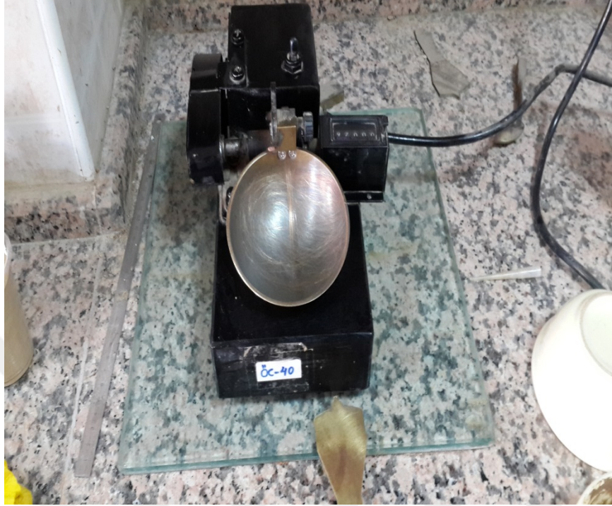
Şekil 2.9. Casagrande aleti ile likit limit değerinin belirlenmesi
