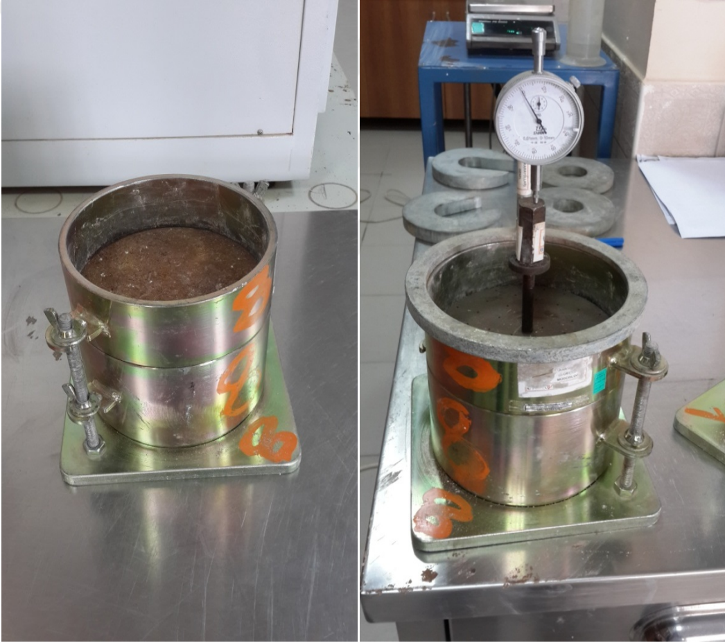
Şekil 2.1. CBR testi için numunelerin hazırlanması
