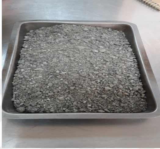
Şekil 2.4. Deneylerde kullanılan iki farklı granülometrideki kolemanit
