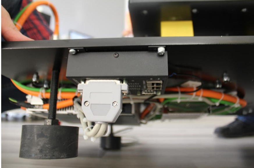
Şekil 2.5. Kontroller bağlantı noktaları
