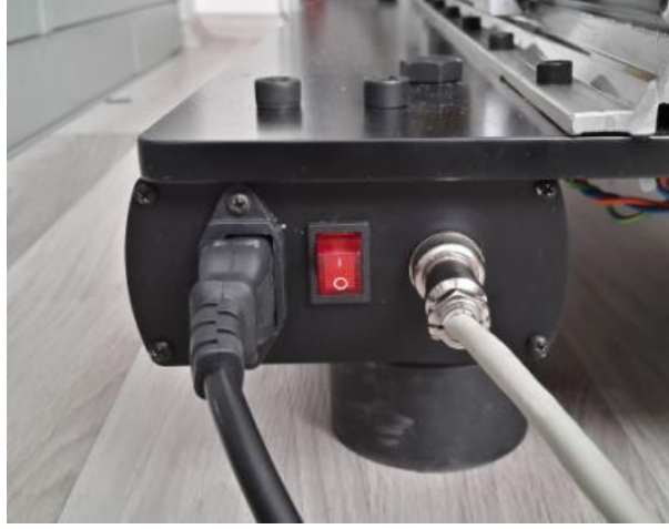
Şekil 2.2. Güç ve acil buton bağlantısı
