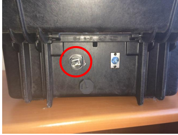
Şekil 2.20. Veri toplama sisteminin sarsma masasına bağlantı soketi
