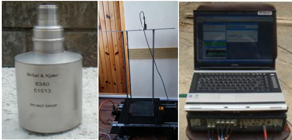
Şekil 2.26. Deneysel modal analiz yöntemiyle dinamik karakteristiklerin belirlenmesi
