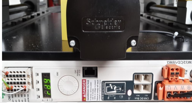
Şekil 2.6. Motor sürücü üzerindeki mini ekranda hazır (rdy) işareti
