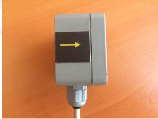
Şekil 2.19. İvmeölçer ve ölçüm yönünü gösteren işaret
