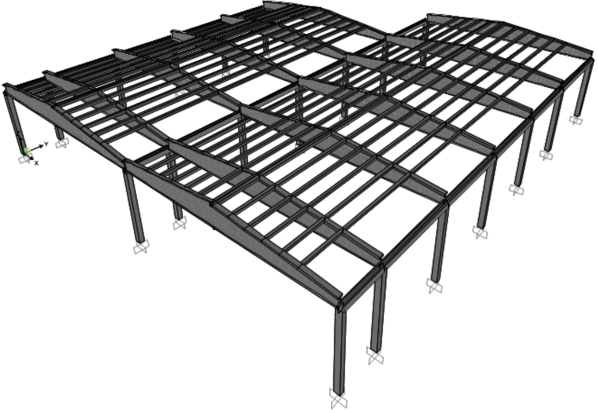
Şekil 2.31. Prefabrik yapının üç boyutlu sonlu elemanlar modeli
