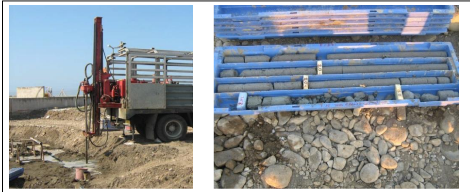
Şekil 63. Jet grout kolonlarından tam boy karot alınması
