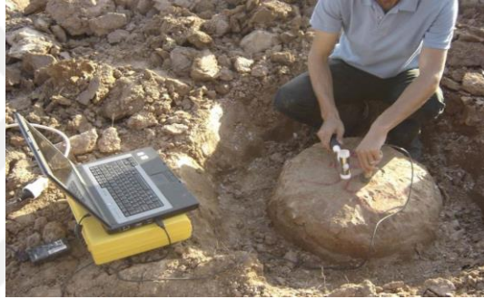
Şekil 37. Jet grout kolonu süreklilik (integrity) deneyi (URL-5).
