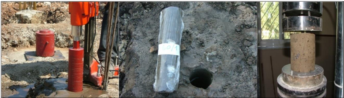
Şekil 35. Karot numune alımı ve serbest basınç deneyi (URL-5).
