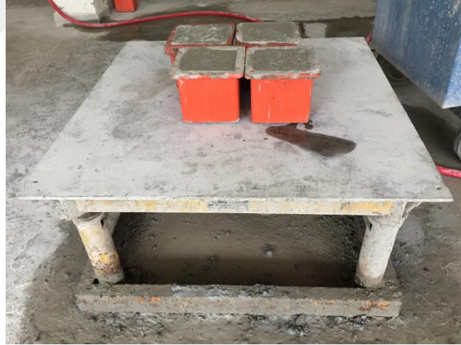
Şekil 2.10. Titreşim tablası ve alınan küp numuneler
