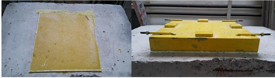
Şekil 2.18. Betonarme blok üzerine kükürt tabaka uygulaması ve üzerindeki çelik levha
