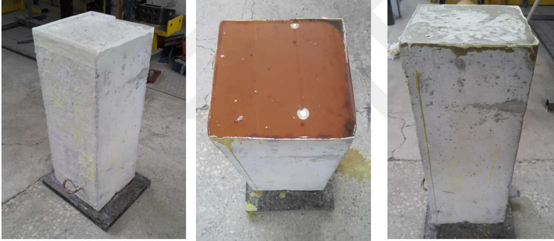
Şekil 2.16. Deney kolonlarının tabanına kükürt tabaka uygulanması
