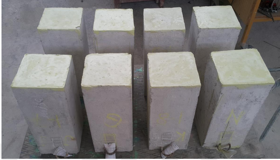
Şekil 2.17. Kükürt tabaka uygulanmış deney kolonları
