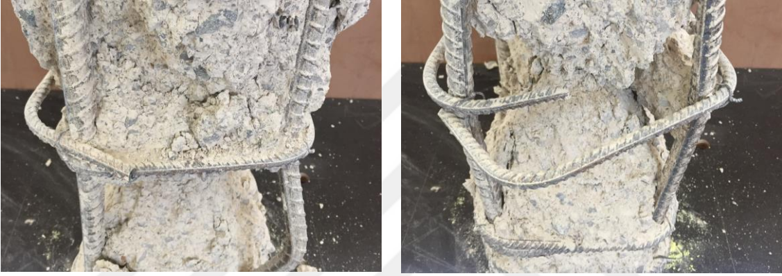
Şekil 3.1. Numunelerde etriye açılması
