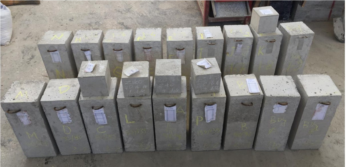
Şekil 2.14. Kür işlemi bitmiş betonarme kolon numunelerinin görünümü
