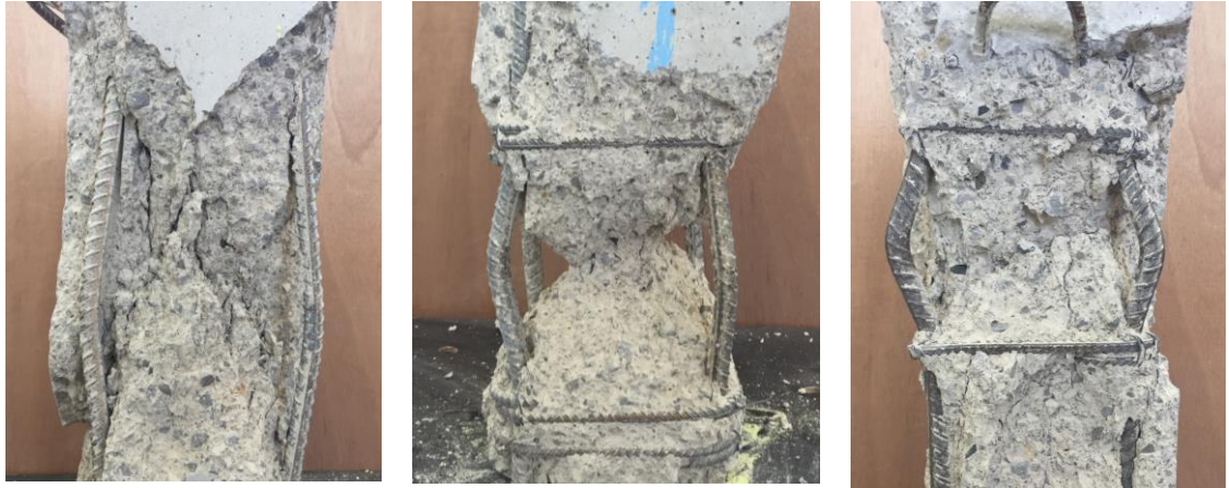
Şekil 3.2. Numunelerde boyuna donatı burkulması
