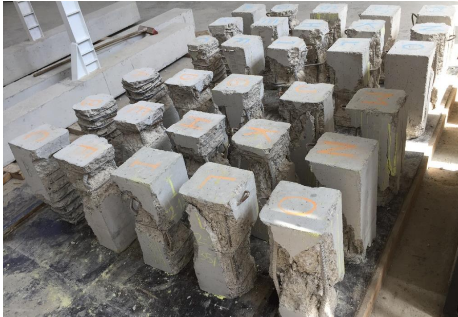
Şekil 2.26. Eksenel yükleme deneyleri uygulanan numunelerin görünümü
