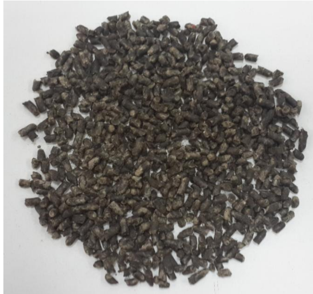
Şekil 19. Süzülme önleyici selüloz fiber katkısı
