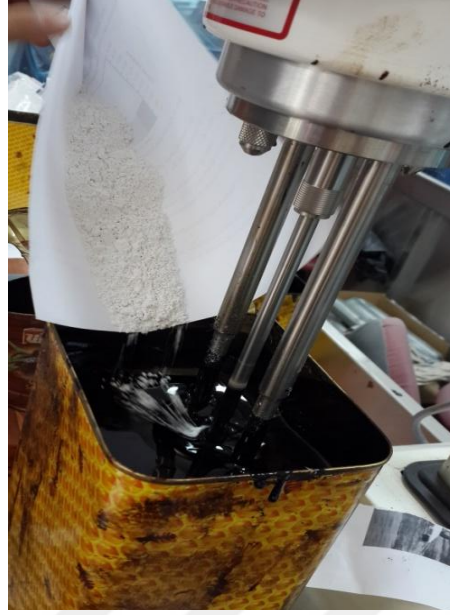
Şekil 17. Bitümün modifiye edilmesi
