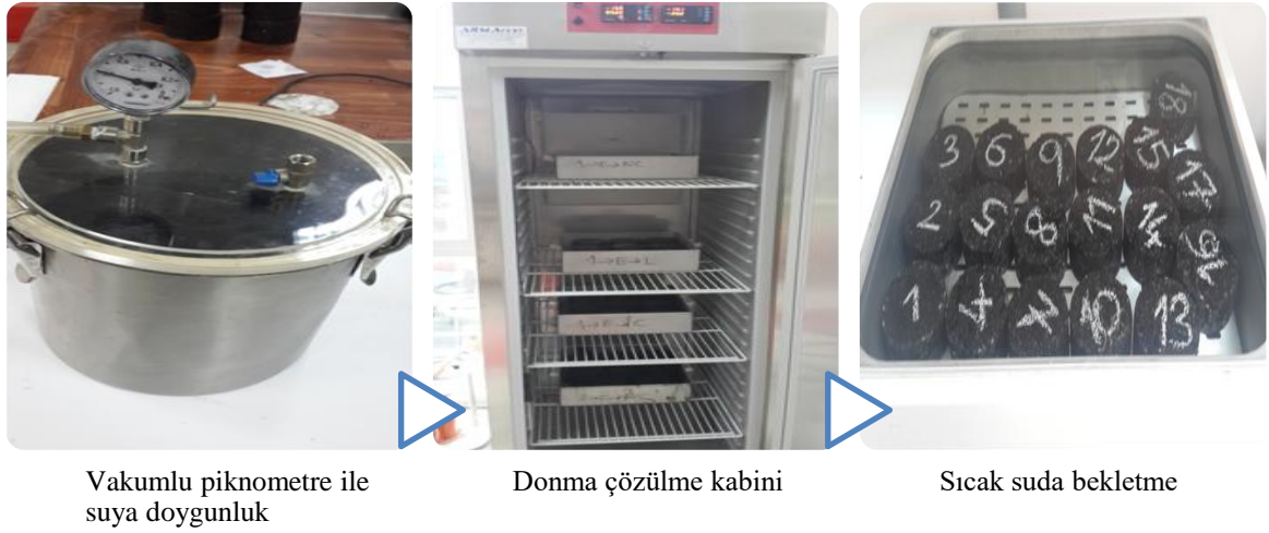
Şekil 21. AASHTO T 283 yönteminde koşullama aşamalarının gösterimi
