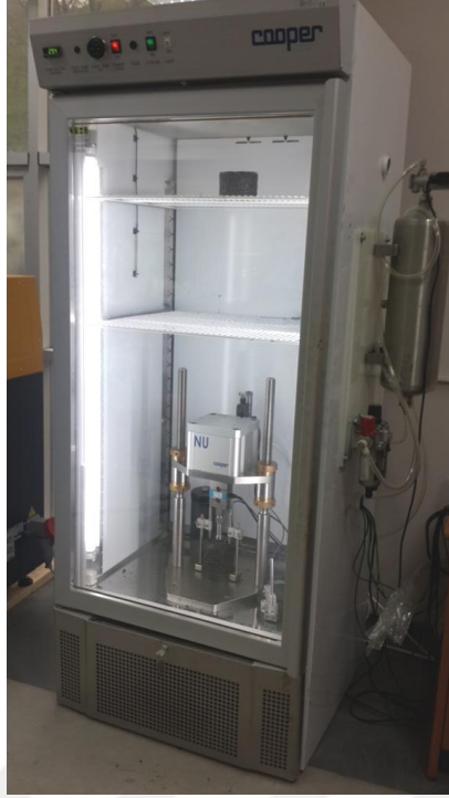
Şekil 26. Üniversal asfalt deney cihazı (NAT)
