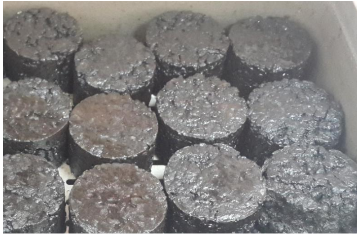
Şekil 63. Koşullaması sonrası dağılan örneklerden bir görüntü
