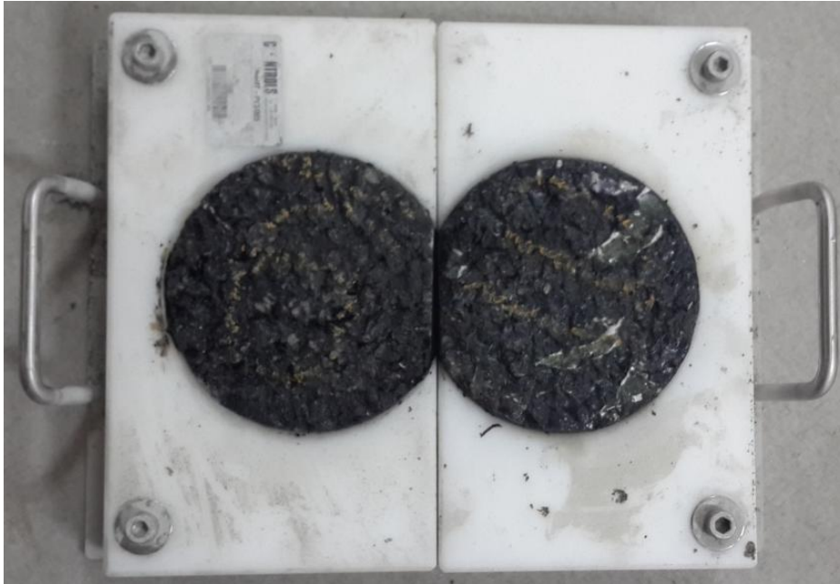
Şekil 28. Kenarları kesilerek HWT cihazı kalıbına yerleştirilen 150mm çaplı ikili örnek
