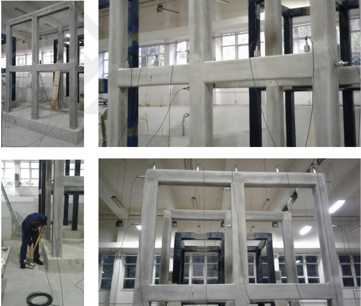
Şekil 2.76. Betonarme düzlem çerçeve sistemi üzerinde gerçekleştirilen deneysel ölçümlere ait bazı fotoğraflar
