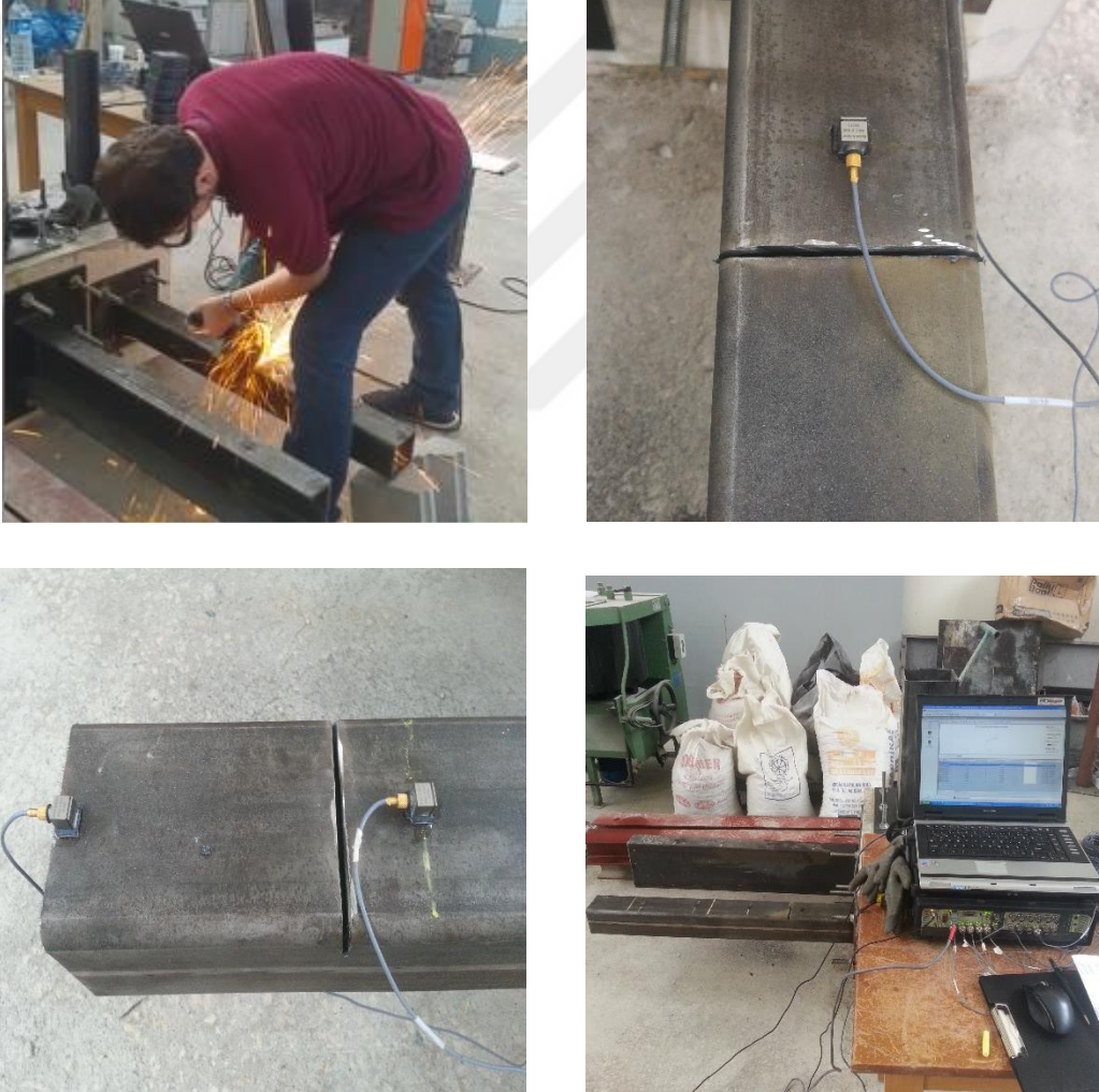
Şekil 2.43. Laboratuvar ortamında hazırlanan kutu kesitli çelik konsol kiriş modeli
