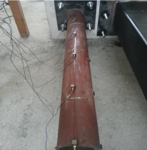
Şekil 2.8. Laboratuvar ortamında inşa edilen boru kesitli çelik konsol kiriş modeli
