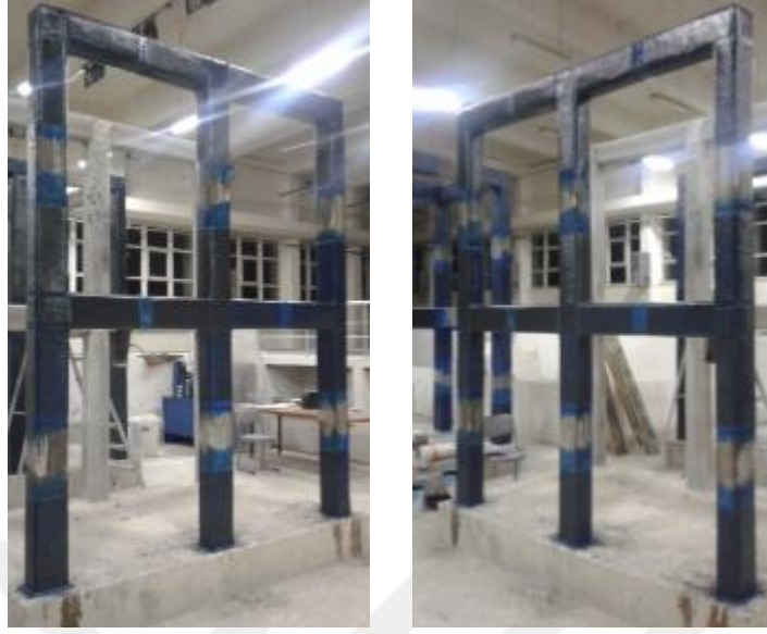
g) LP kumaş sargılama aşamasının tamamlanmış hali
