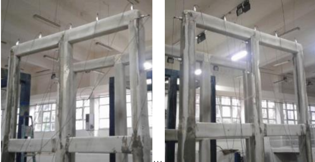
Şekil 2.12. Hasarlı betonarme düzlem çerçeve modeli üzerinde gerçekleştirilen ölçümlere ait bazı fotoğraflar
