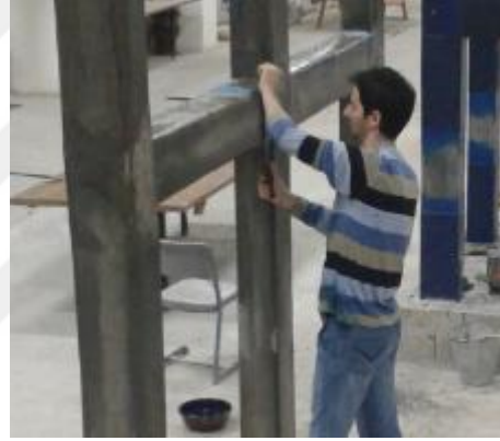
e) Epoksi esaslı yapıştırıcının hazırlanması ve eleman yüzelerindeki pürüzlerin giderilmesi
