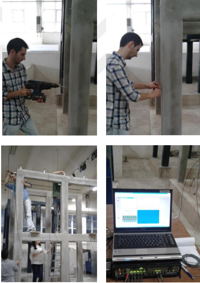
Şekil 2.5. Deneysel ölçümler için ivmeölçer bağlantı noktalarının hazırlanması
