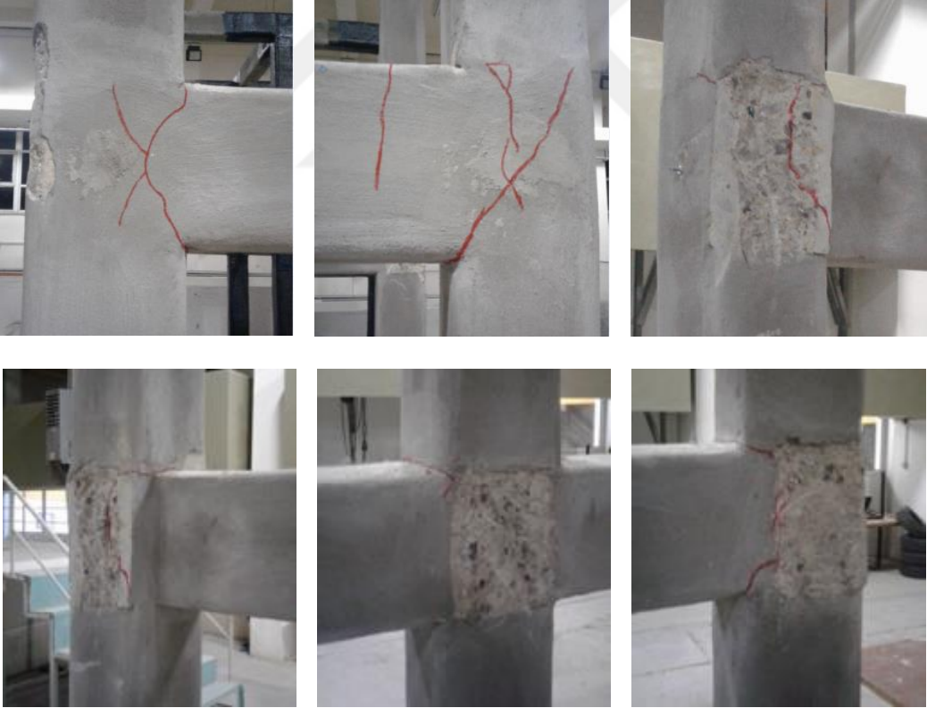
Şekil 2.11. Çerçeve modelinin hasar durumuna ait bazı fotoğraflar
