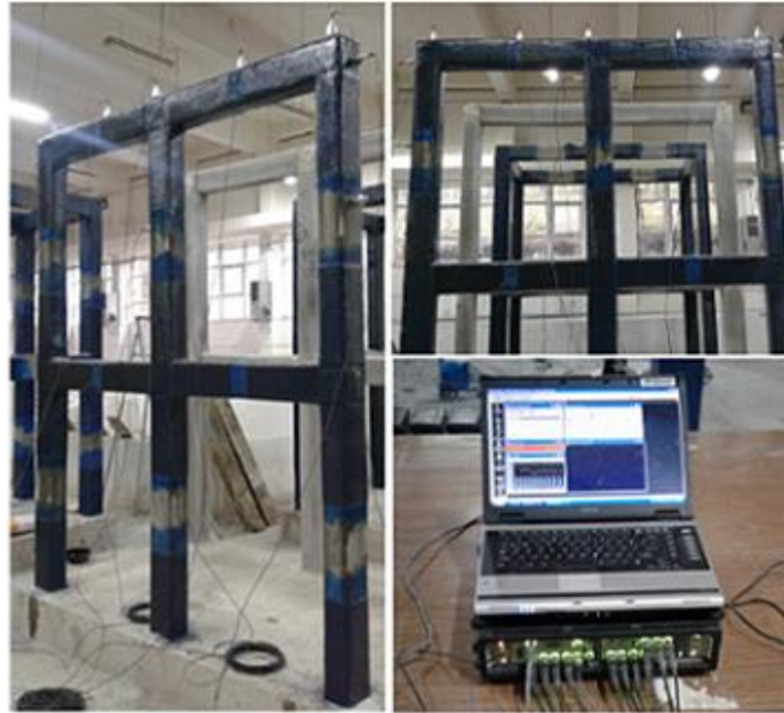
Şekil 2.25. LP kompozit güçlendirmeden sonra çerçeve modeli için gerçekleştirilen çevresel titreşim testi
