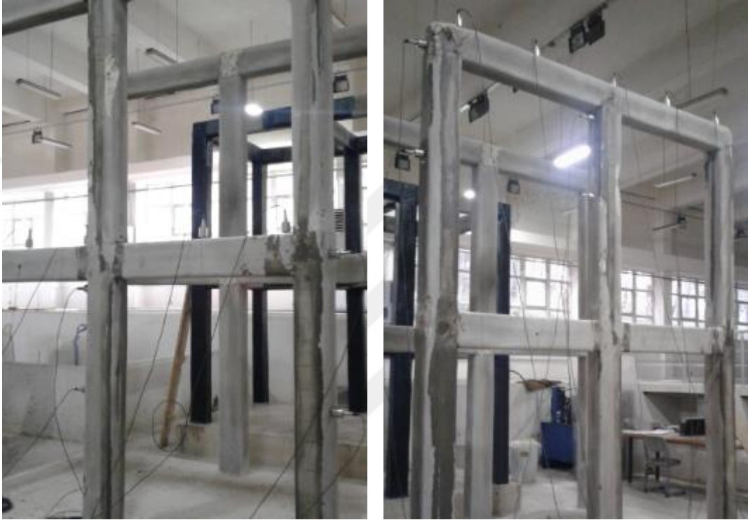
Şekil 2.18. Onarılmış betonarme çerçeve modeli üzerinde gerçekleştirilen ölçümlere ait bazı fotoğraflar
