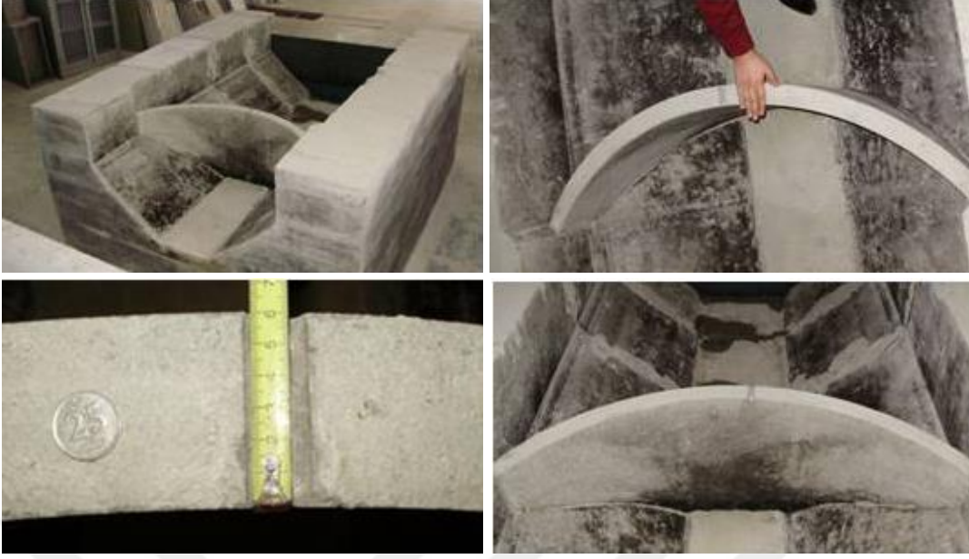
Şekil 2.6. Tip-1 kemer barajın laboratuvar modeline ait bazı fotoğraflar (Sevim, 2010).
