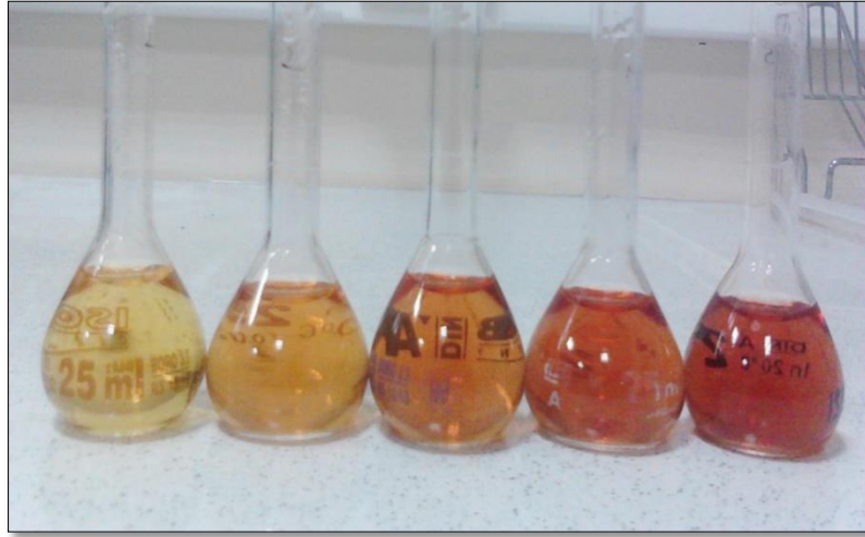
Şekil 11. Klorofenol standartlarının 4-aminoantipirin ve \text{K}_3[\text{Fe}(\text{CN})_6] ile renklendirilmesi.
