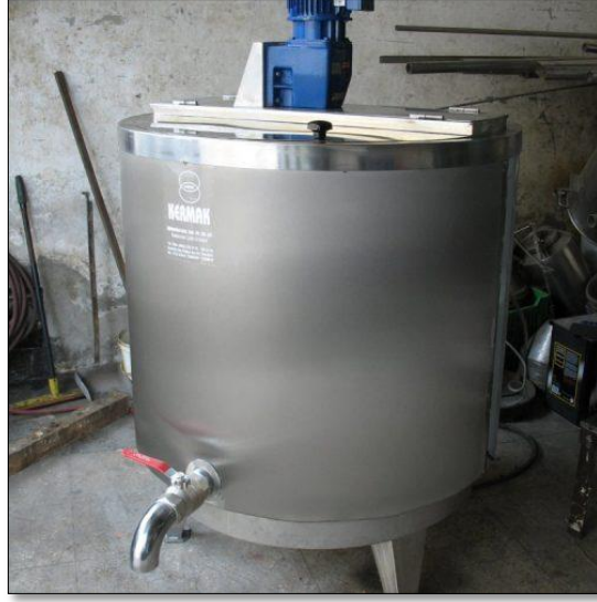
Şekil 8. Buhar cıdarlı pişirici kazan
