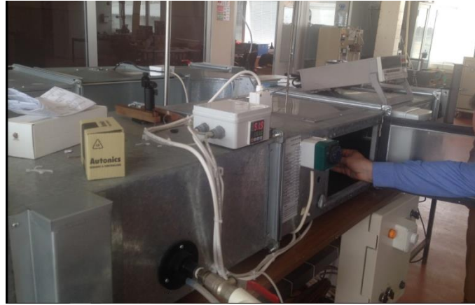
Şekil 14. Konvektif bant kurutucu ve kurutma çalışmaları
