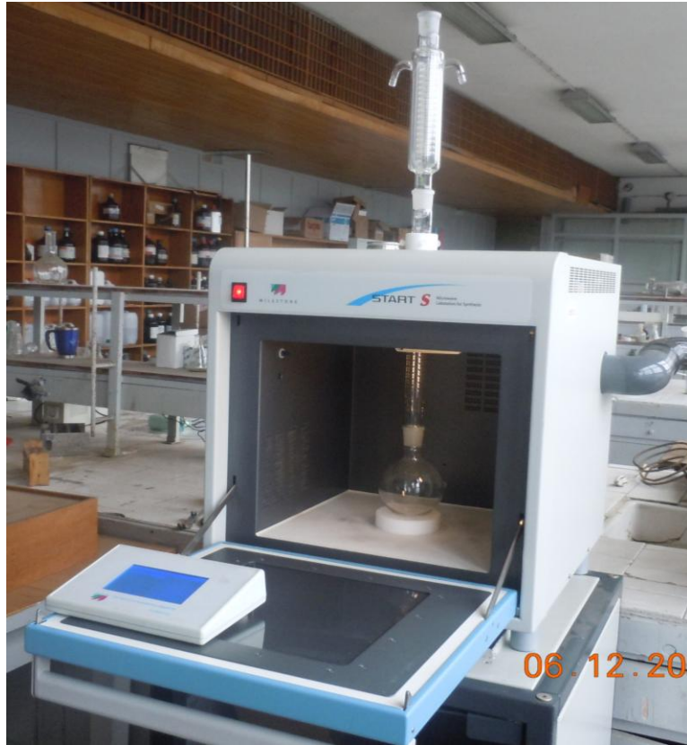
Şekil 20. Normal basınç reaktörü (atmosferik basınç altında sıcaklık kontrollü geri soğutucu altında ısıtma sistemi)
