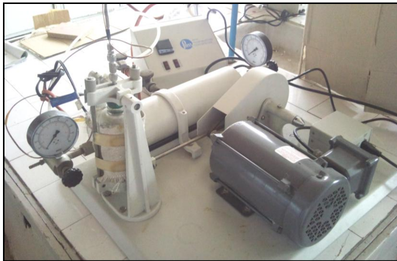
Şekil 24. Düşük basınçlı Parr hidrojenasyon cihazı 1
