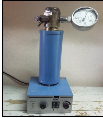
Şekil 26. Yüksek basınçlı Parr hidrojenasyon cihazı 3
