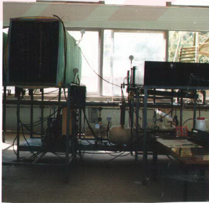
Şekil 3.8. Hava ve Su Kaynaklı Isı Pompası Sistemi.
