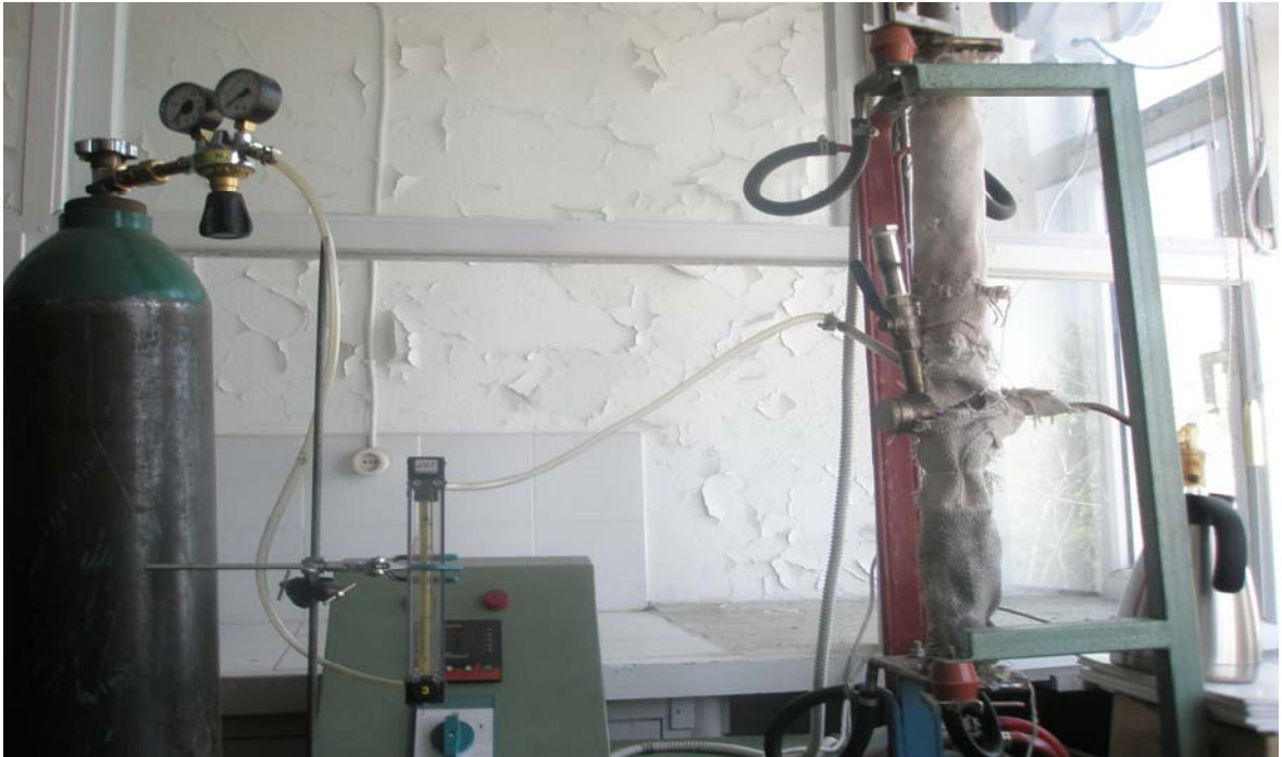
Şekil 14. Hızlı piroliz deney düzeneğini resmi
