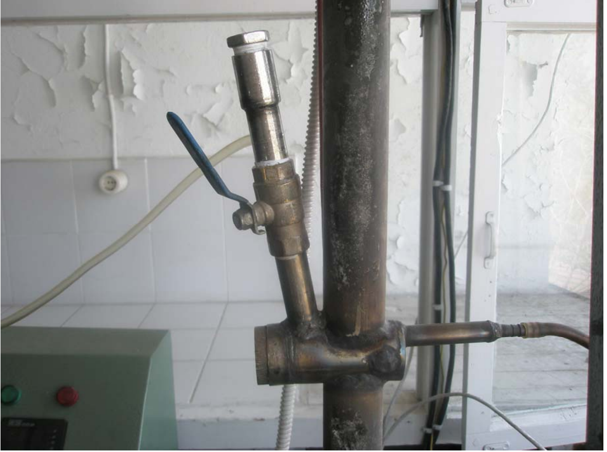
Şekil 15. Hızlı piroliz deney düzeneği reaktör resmi
