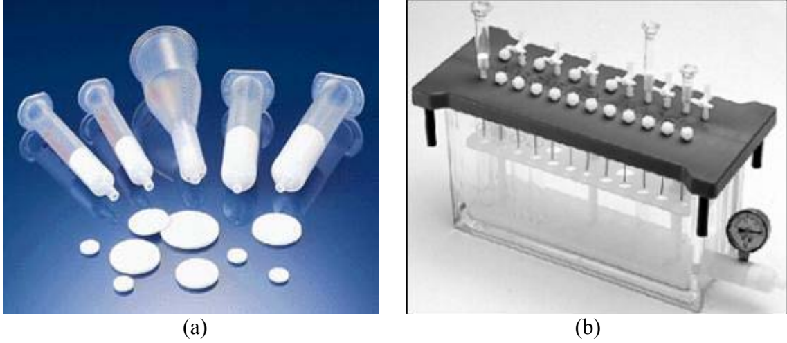
Şekil 5. (a) Çeşitli ticari SPE kolon ve diskleri (b) Vakum manifoldu
