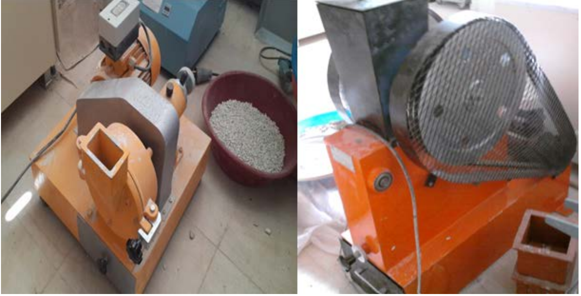
Şekil 2.8. Taşların toz haline getirilmesinde kullanılan öğütme ve taş kırma makineleri
