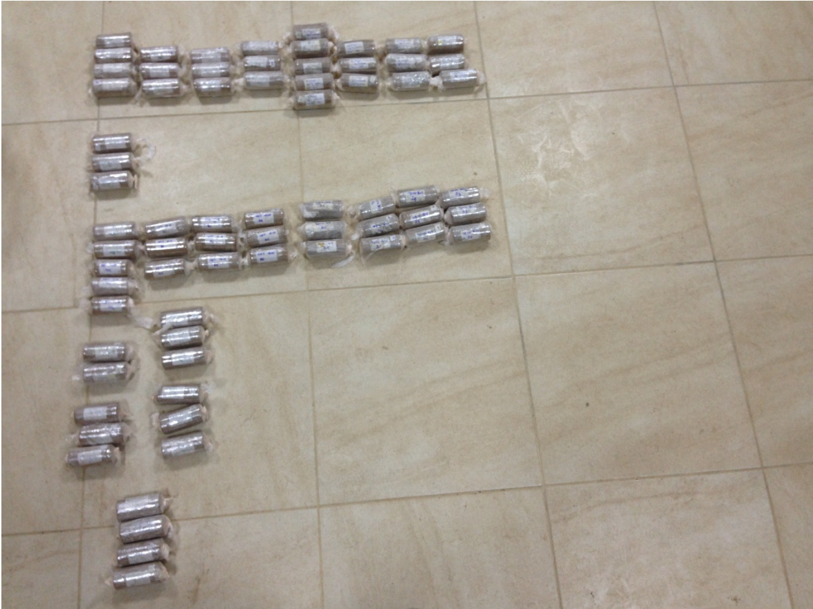
Şekil 3.20. Serbest basınç deneyi numuneleri
