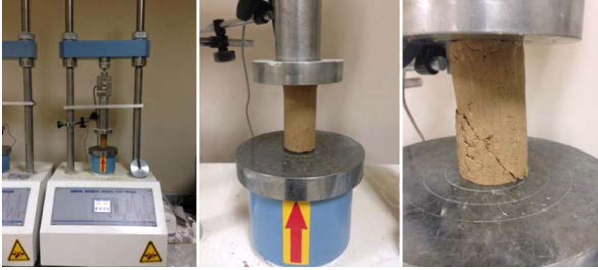
Şekil 3.23. Tek eksenli serbest basınç dayanımı testi
