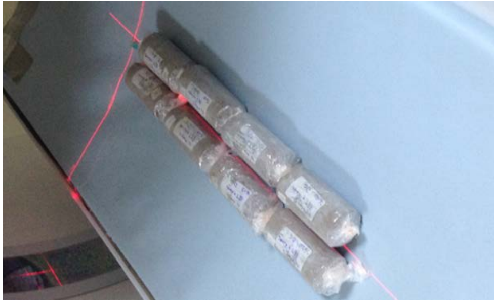
Şekil 3.48. Numunelerin bilgisayarlı tomografi cihazına yerleştirilmesi
