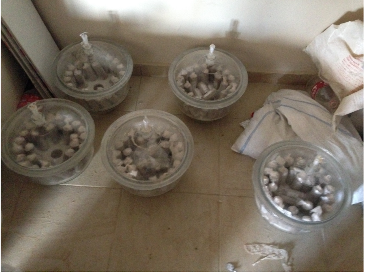
Şekil 3.21. Deney numunelerine desikatör içerisinde 28 günlük kür uygulama
