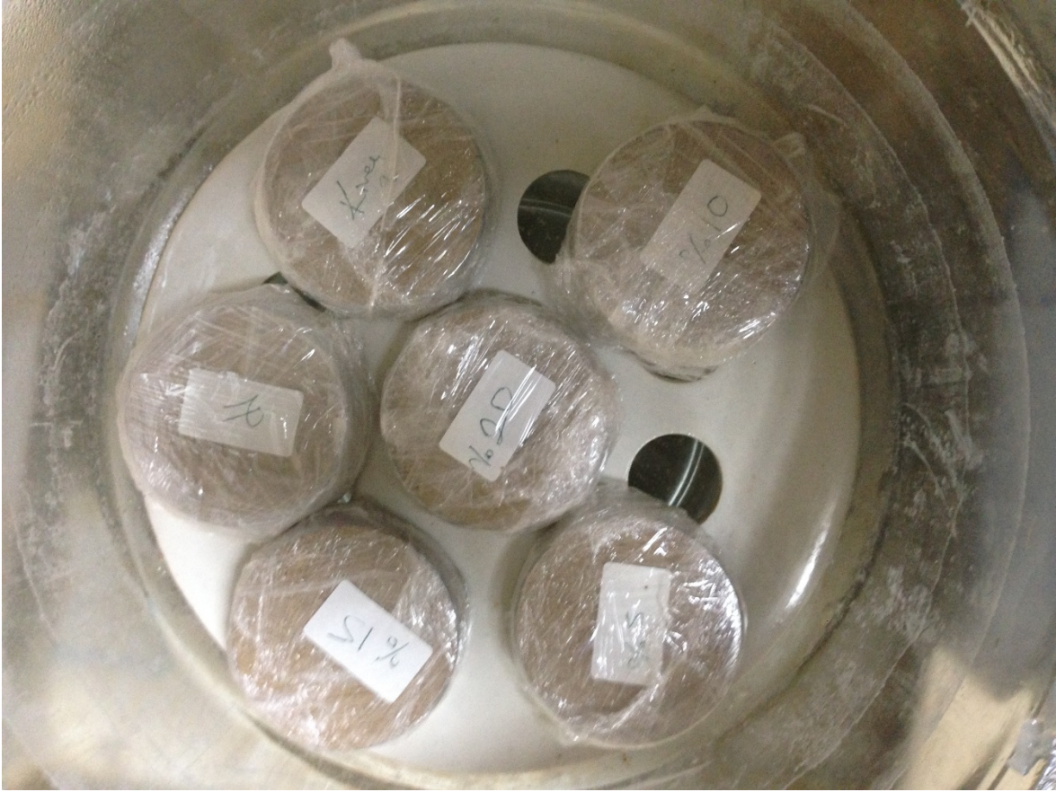
Şekil 3.40. Şişme yüzdesi deney numuneleri
