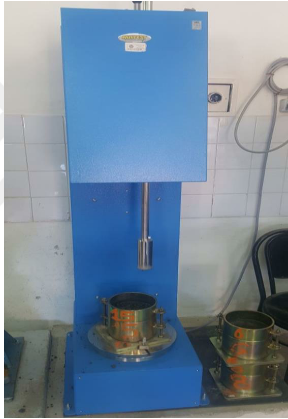
Şekil 13. Numunelerin modifiye proktor ile sıkıştırılması
