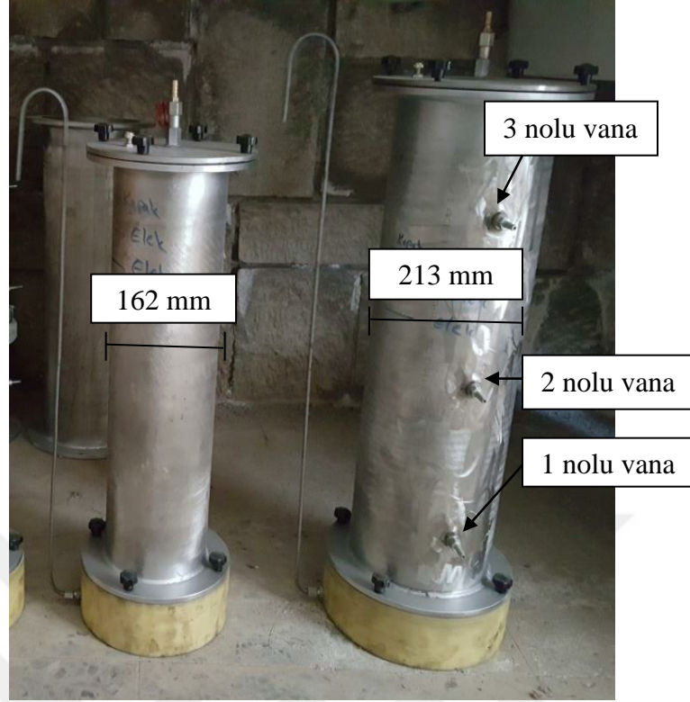
Şekil 17. Sabit seviyeli permeabilite test silindirleri
