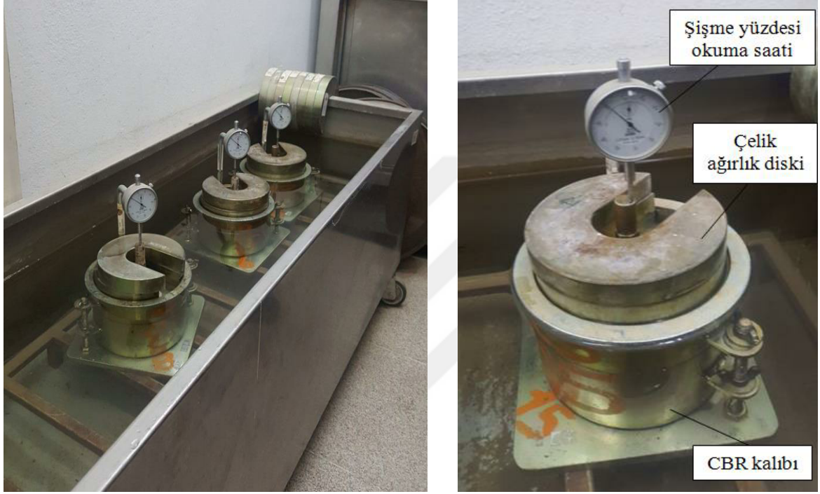
Şekil 16. Yaş CBR testi su havuzu ve şişme yüzdesi için kullanılan okuma saati
