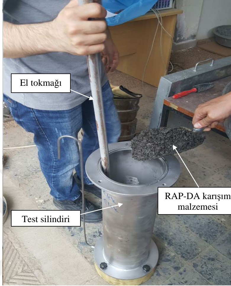
Şekil 19. Malzemelerin silindire yerleştirilmesi ve sıkıştırılması
