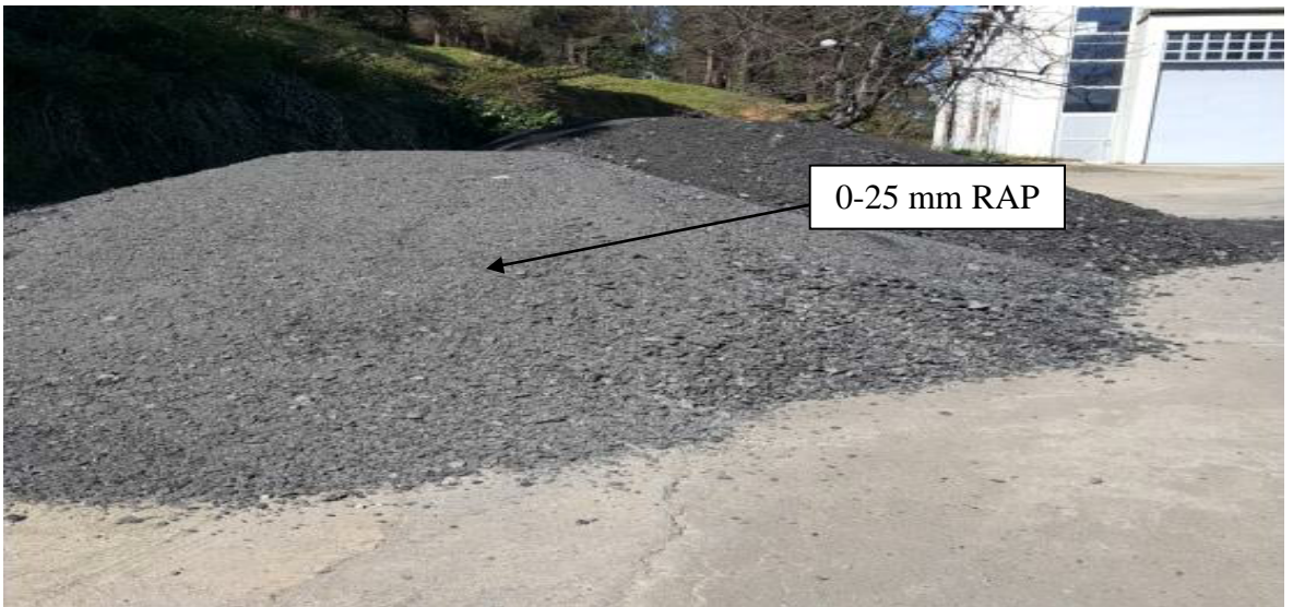
Şekil 10. Depolanan RAP malzemesi
