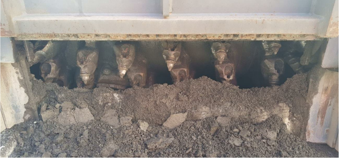
Şekil 9. Kazıma makinesinin kristal uçlu dişleri
