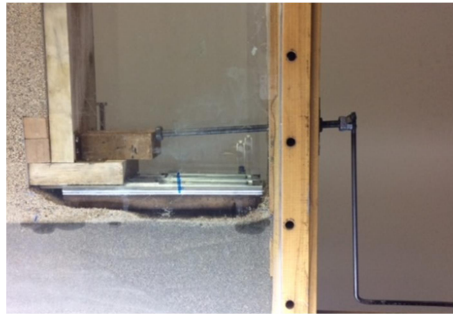
Şekil 2.11. Zemin itkisi ile duvar ötelenmesinde kullanılan mekanizma.
