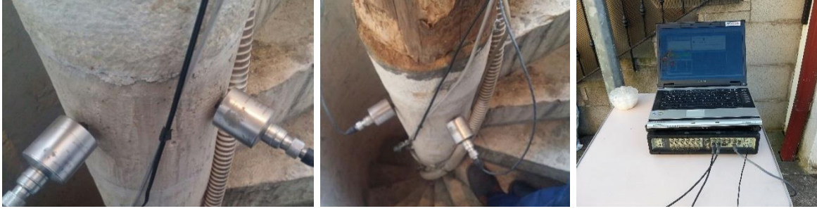
Şekil 2.334. Küçük Fatih Camii Minaresi restorasyon sonrası ölçüm görüntüleri
