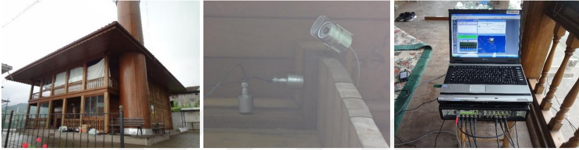
Şekil 2.392. Kuşluca Camii restorasyon sonrası ölçüm görüntüleri
