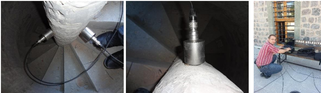
Şekil 2.166. Tahtalı Camii Minaresi yapım sonrası ölçüm görüntüleri
