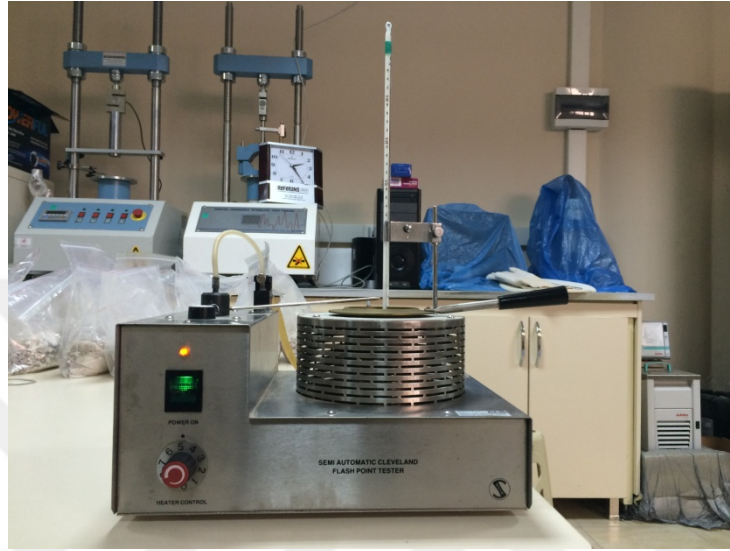
Şekil 6. Parlama noktası deney aleti
