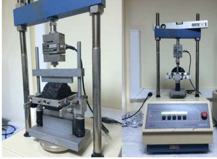
Şekil 34. Dolaylı çekme mukavemeti deneyi
