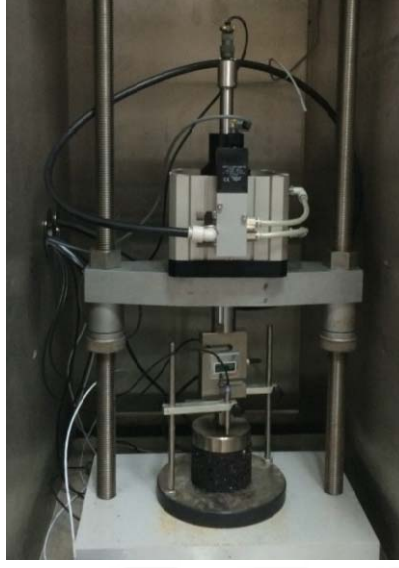
Şekil 38. Dinamik sünme deney düzeneği
