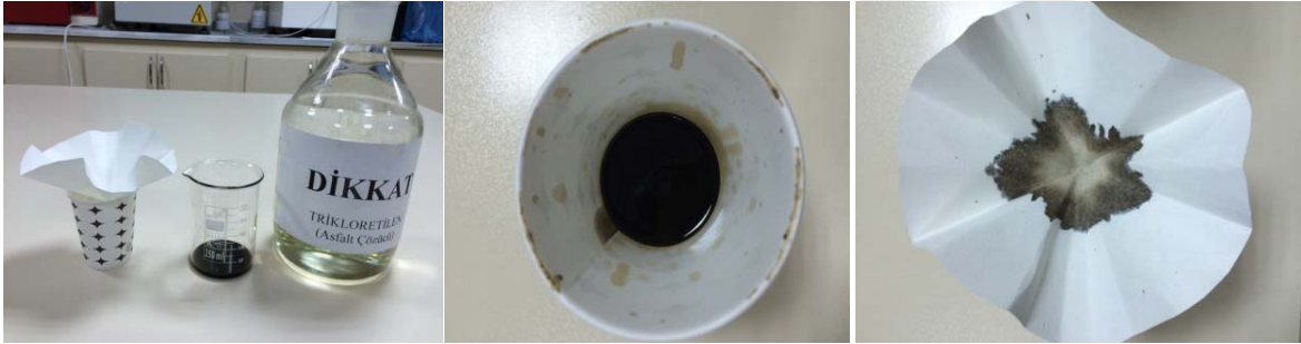
Şekil 72. %6 katkı içerikli asfalt bağlayıcının trikloretilende çözünmesi
