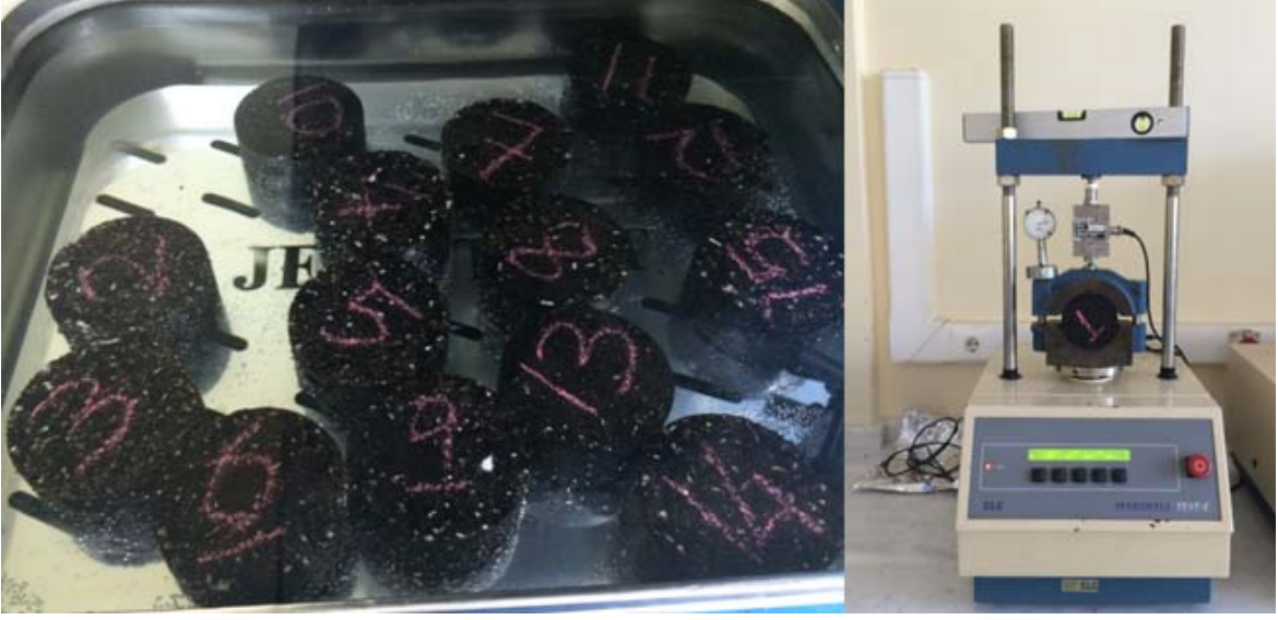
Şekil 33. Briketlerin su banyosunda kür edilmesi ve Marshall deneyi
