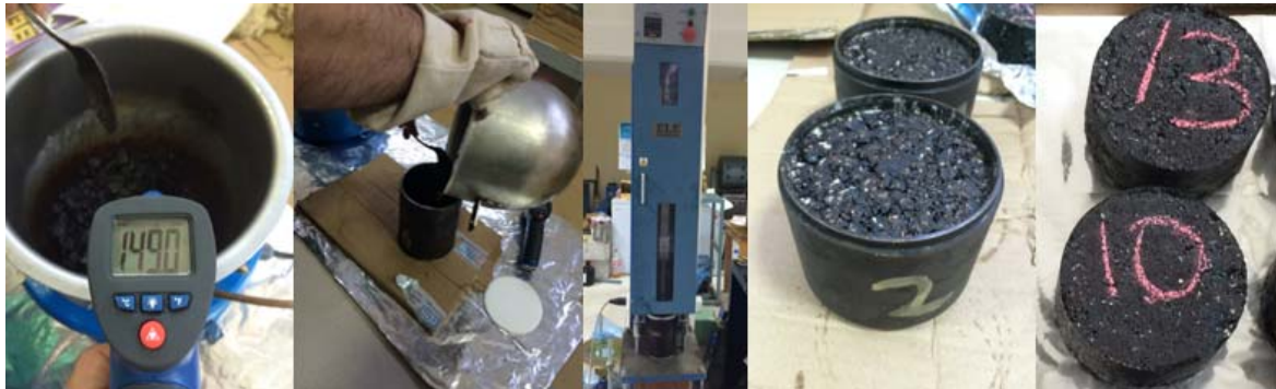
Şekil 32. Marshall briketi üretimi
