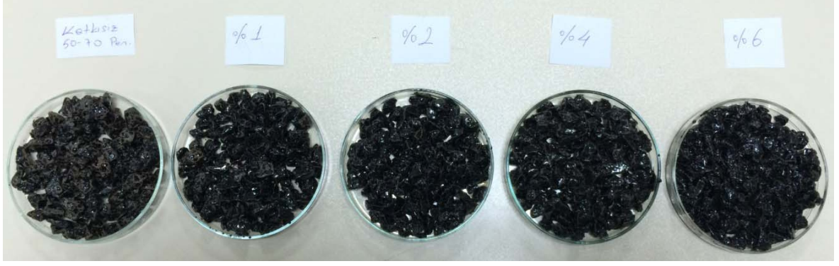
Şekil 74. Nicholson soyulma deneyi sonrası sıkıştırılmamış karışımların görüntüsü
