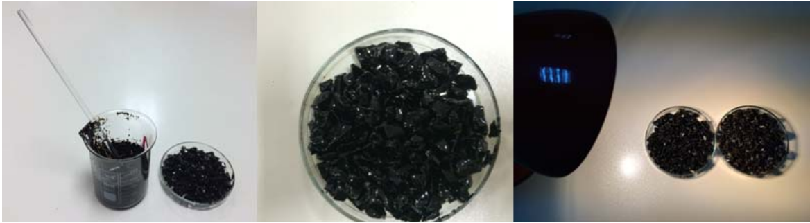
Şekil 9. Nicholson soyulma deneyi
