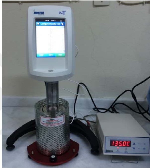
Şekil 10. Brookfield viskozimetre deney aleti
