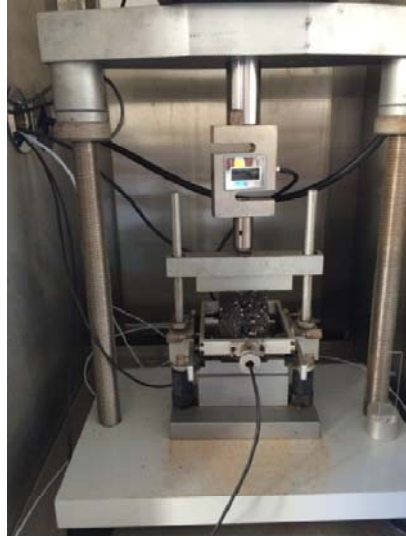
Şekil 36. Dolaylı çekme deneyi
