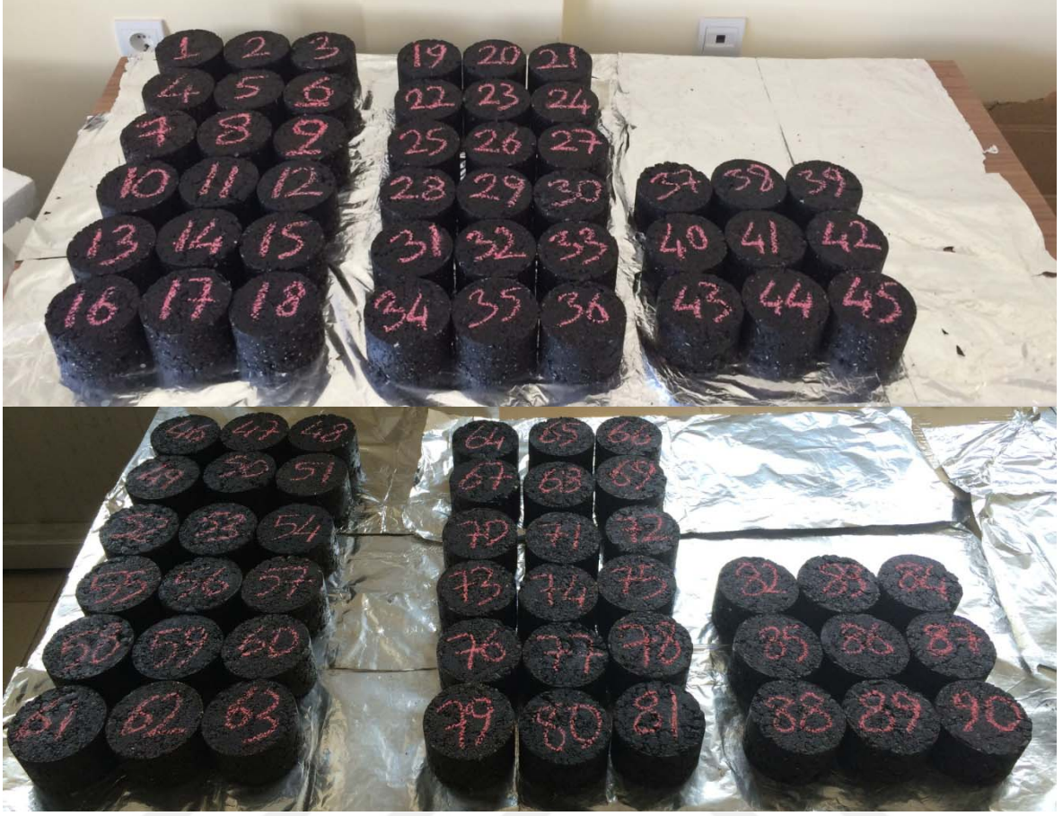
Şekil 55. Üretilen Marshall briketleri
