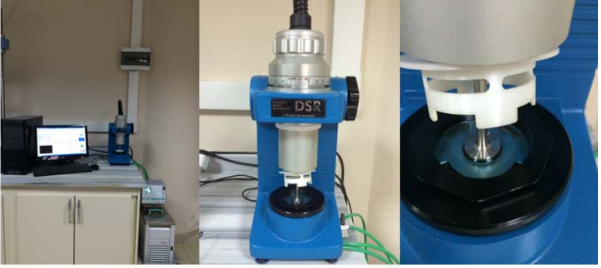
Şekil 12. Bohlin DSR II dinamik kayma reometrisi
