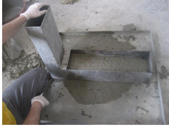
Şekil 5.4. L Kutusu deneyi
