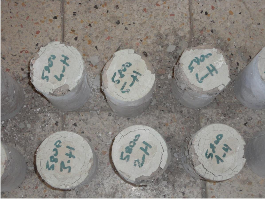
Şekil 6.4. CEM II 42,5 (B-M) (P-L) L N çimentosu 0,45 s/ç oranında ve 800°C de işlem gören numuneler
