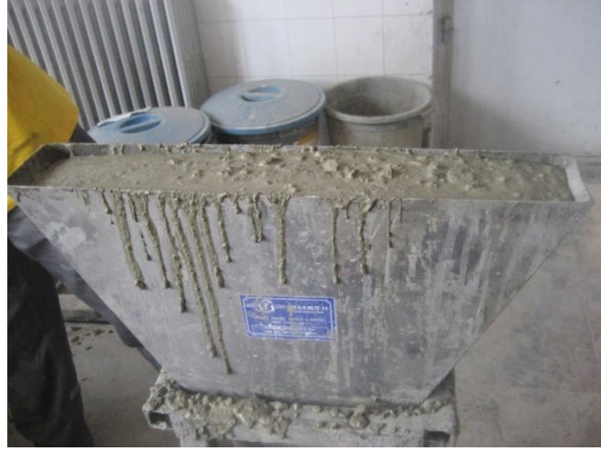
Şekil 5.3. V Hunisi deneyi
