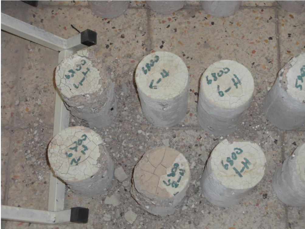
Şekil 6.3. CEM II 42,5 (B-M) (P-L) L N çimentosu 0,40 s/ç oranında ve 800°C de işlem gören numuneler
