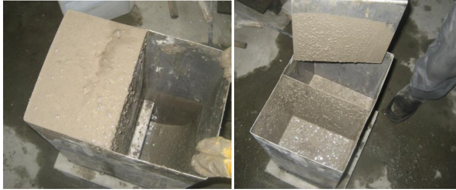
Şekil 5.5. U kutusu deney düzeneği
