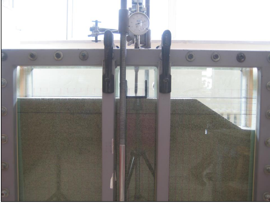
Şekil 2.9. Merkezi yüklü şerit temelle yapılan bir deneyde, yüklemenin başlangıç hali
