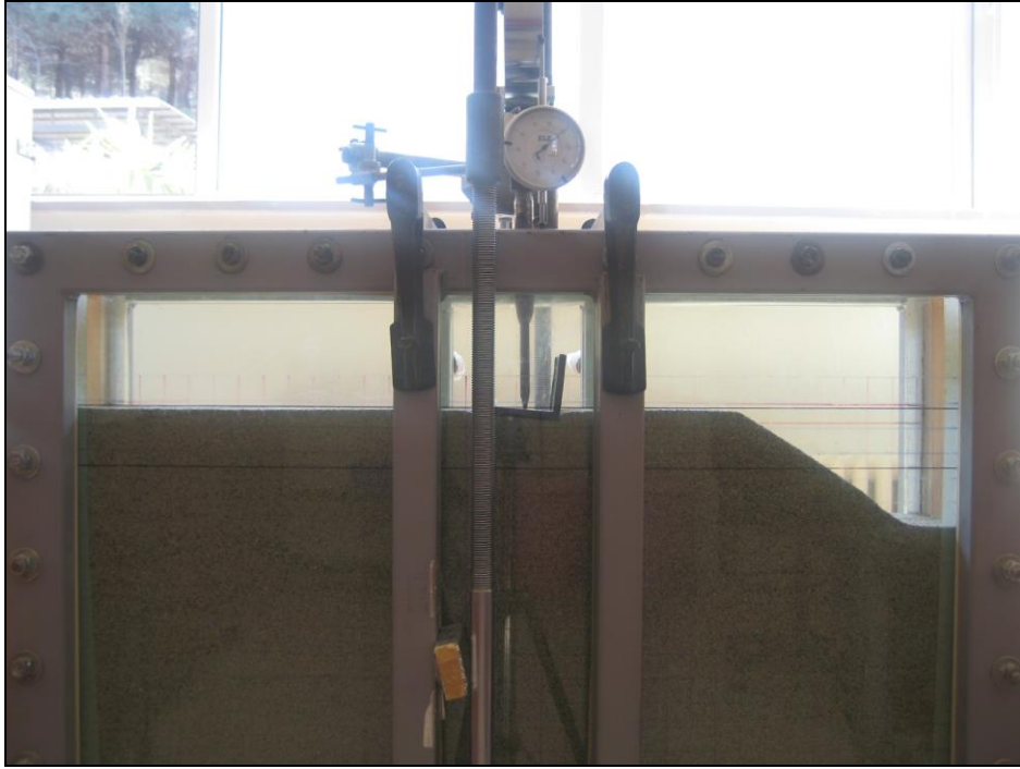
Şekil 2.12. Eksantrisitenin çekirdek içinde olduğu şerit temelle yapılan bir deneyde, yüklemenin bitiş hali
