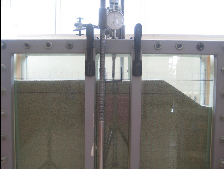
Şekil 2.10. Merkezi yüklü şerit temelle yapılan bir deneyde, yüklemenin bitiş hali
