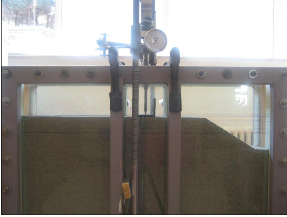
Şekil 2.11. Eksantrisitenin çekirdek içinde olduğu şerit temelle yapılan bir deneyde, yüklemenin başlangıç hali
