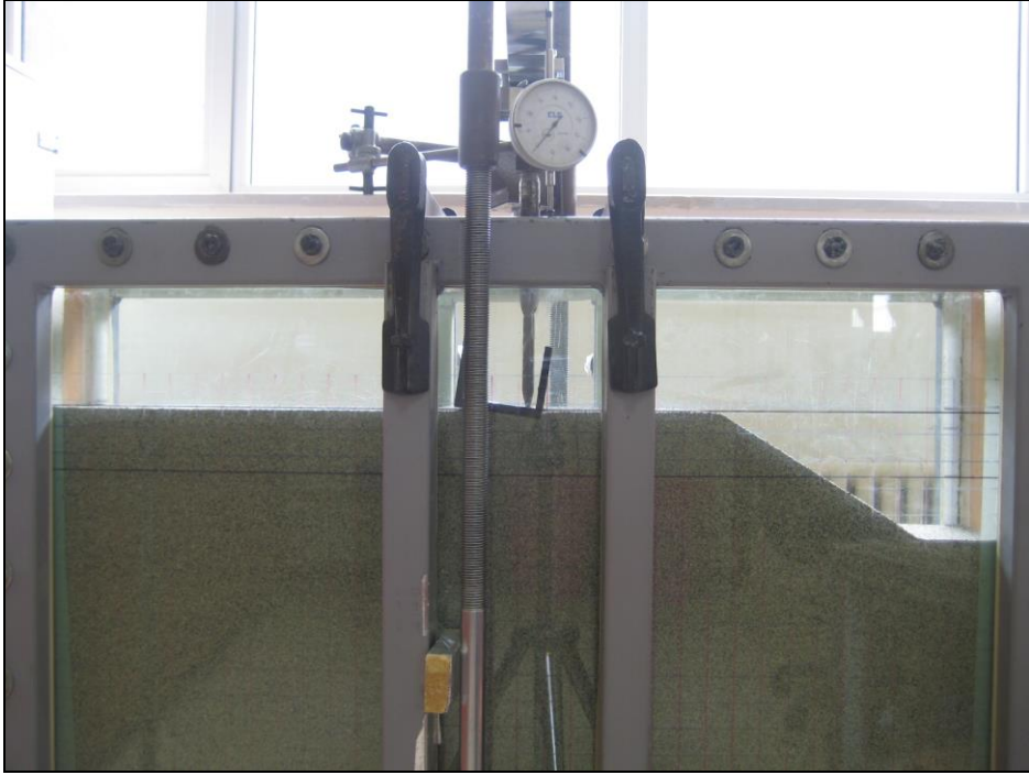
Şekil 2.16. Eksantrisitenin çekirdek dışında olduğu şerit temelle yapılan bir deneyde, yüklemenin bitiş hali
