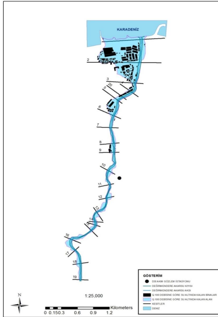
Şekil 3.3. 100 yıl tekerrürlü taşkında su altında kalacak binaların genel görünümü
