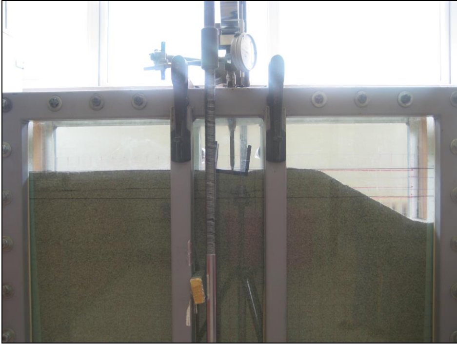
Şekil 2.17. Donatılı kumda şeve yakın oturan eksantrisitenin çekirdek içinde olduğu şerit temel ile yapılan bir deneyde, yüklemenin bitiş hali
