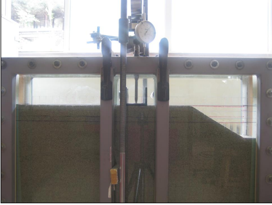
Şekil 2.14. Donatılı kumda şeve yakın oturan merkezi yüklü şerit temel ile yapılan bir deneyde, yüklemenin başlangıç hali
