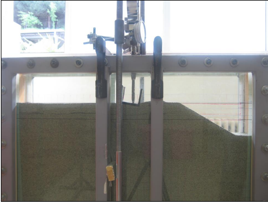
Şekil 2.19. Donatılı kumda şeve yakın oturan eksantrisitenin çekirdek sınırında olduğu şerit temel ile yapılan bir deneyde, yüklemenin bitiş hali
