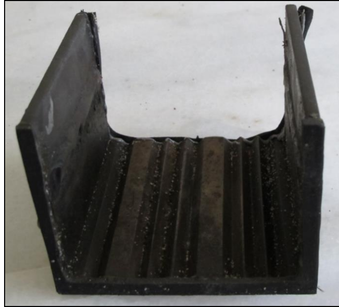
Şekil 2.4. Model şerit temelin fotoğrafı
