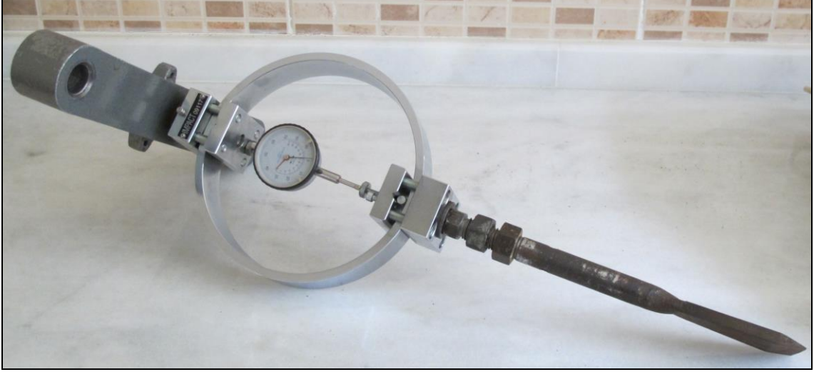
Şekil 2.7. Yük halkası ve yükleme bıçağı
