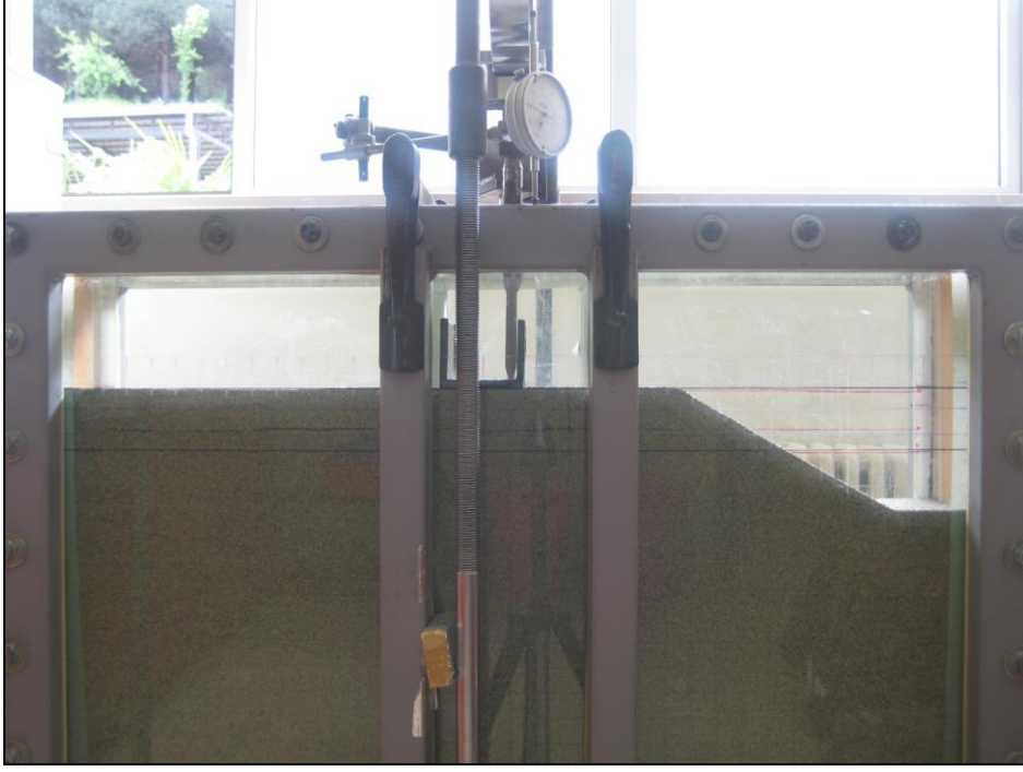
Şekil 2.20. Donatılı kumda şeve yakın oturan eksantrisitenin çekirdek dışında olduğu şerit temel ile yapılan bir deneyde, yüklemenin başlangıç hali
