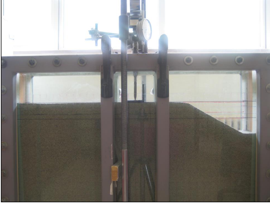
Şekil 2.16. Donatılı kumda şeve yakın oturan eksantrisitenin çekirdek içinde olduğu şerit temel ile yapılan bir deneyde, yüklemenin başlangıç hali
