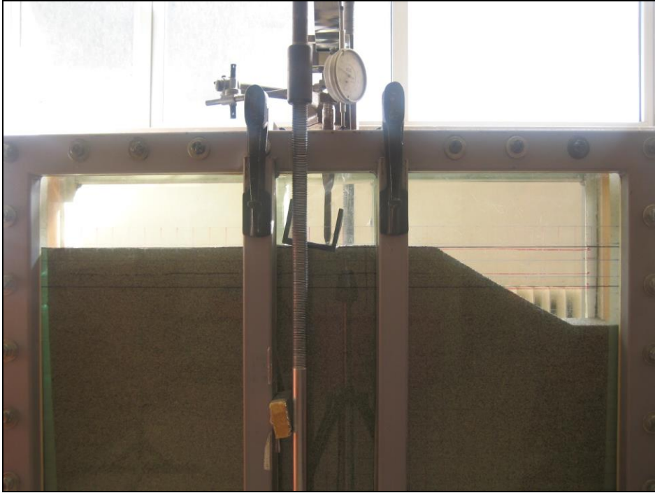
Şekil 2.21. Donatılı kumda şeve yakın oturan eksantrisitenin çekirdek dışında olduğu şerit temel ile yapılan bir deneyde, yüklemenin bitiş hali
