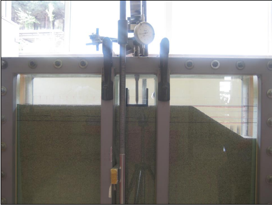
Şekil 2.15. Donatılı kumda şeve yakın oturan merkezi yüklü şerit temel ile yapılan bir deneyde, yüklemenin bitiş hali
