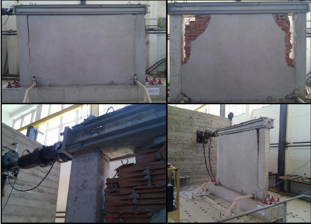
Şekil 3.30. RCF-3 çerçevesinin deney sonundan bazı görüntümler
