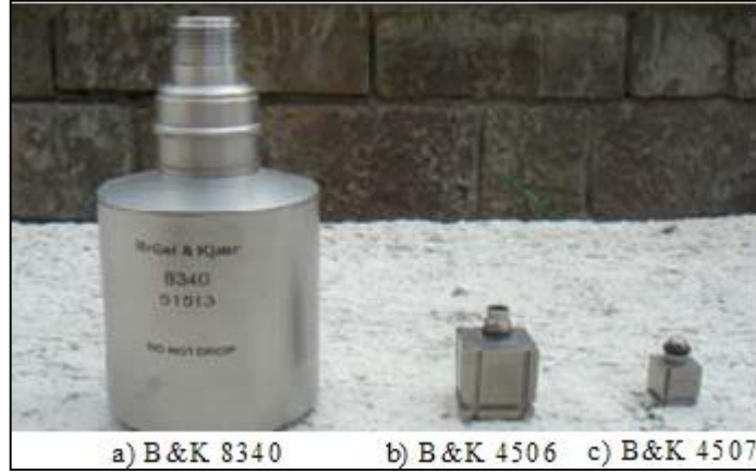
Şekil 1.8. B&K 8340 tipi bir eksenli (a), B&K 4506 tipi üç eksenli (b) ve B&K 4507 tipi bir eksenli (c) ivmeölçerler
