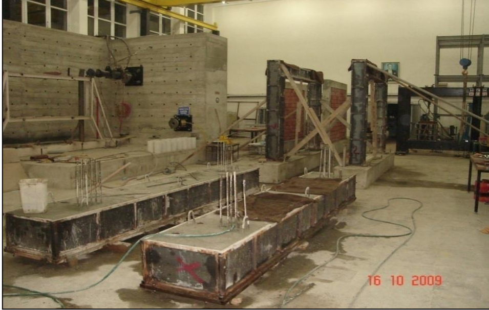
Şekil 2.7. Çerçevelerin ıslak çuval altında saklanmalarına ilişkin bir görünüm
