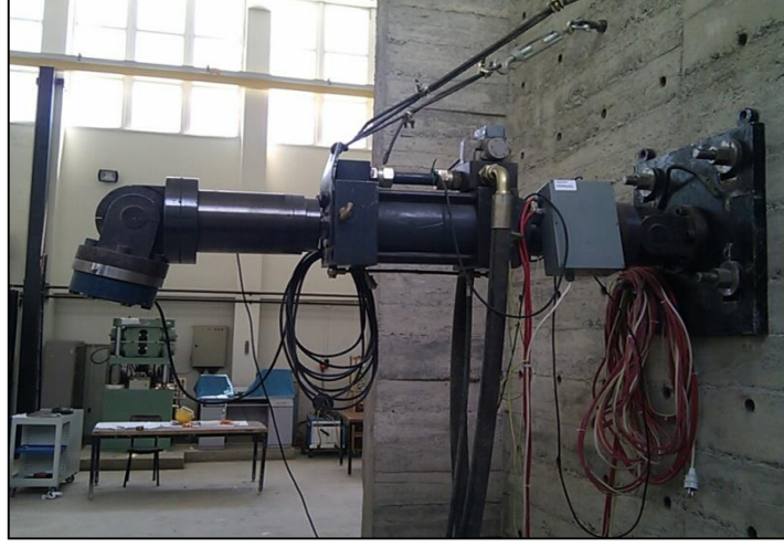
Şekil 2.19. Deney çerçevelerine yatay çevrimsel yük uygulamada kullanılan yükleme sisteminden bir görünüm
