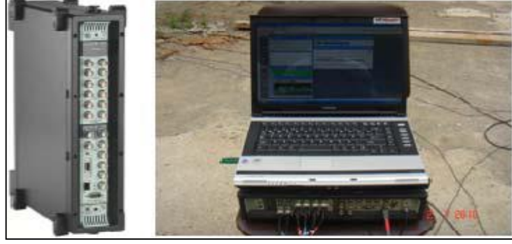
Şekil 1.9. B&K 3560 C tipi 17 kanallı veri toplama ünitesi
