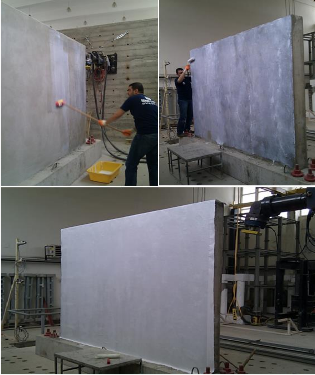
Şekil 2.11. Deprem kumaşının dolgu duvarlı çerçevelere uygulanışından bir görünüm
