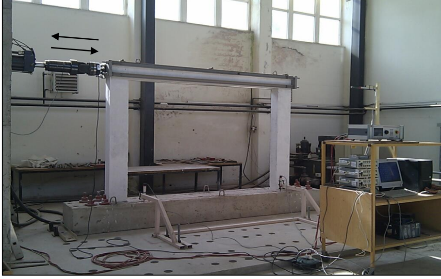
Şekil 3.7. Geleneksel betonla üretilen dolgu duvarsız PRCF-2 çerçevesinin deneyi esnasından bir görünüm
