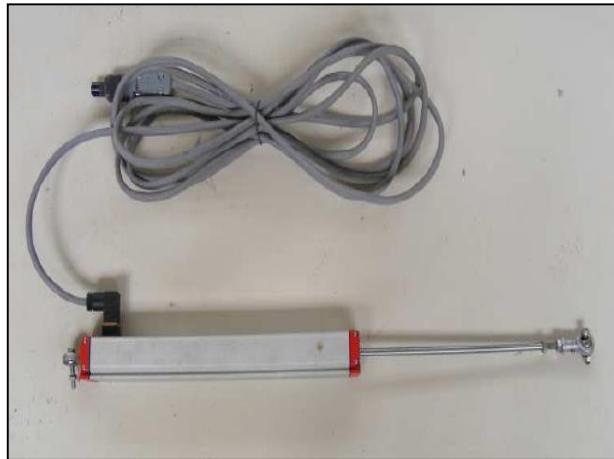
Şekil 2.22. Çevrimsel yükler altında oluşan yerdeğişmelerin ölçülmesinde kullanılan Opkon marka LPM300 kodlu 300mm kapasiteli doğrusal potansiyometrik yerdeğiştirme ölçer
