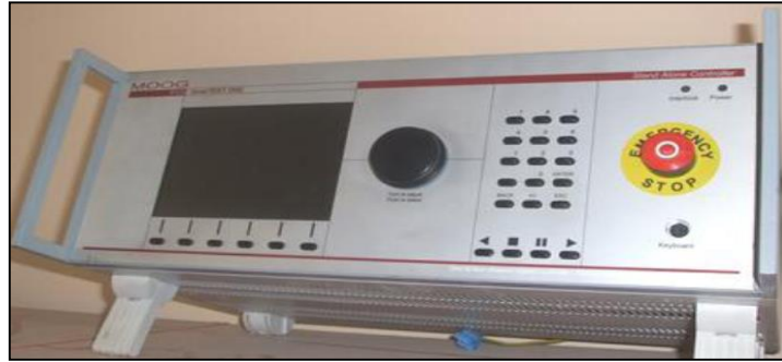
Şekil 2.20. Deney çerçevelerine çevrimsel yatay yükün uygulanmasında kullanılan denetim paneline ilişkin bir görünüm
