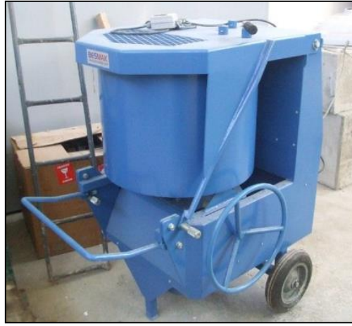
Şekil 2.3. Betonların üretiminde kullanılan düşey eksenli betonyerden bir görünüm
