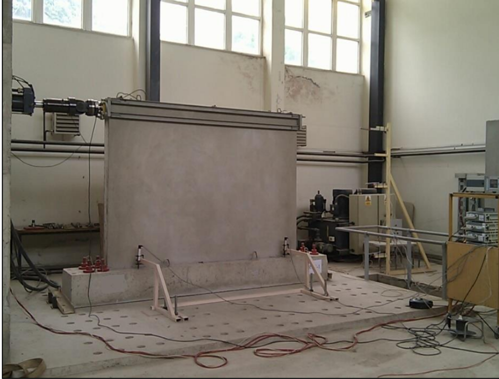
Şekil 3.13. Düşük dayanımlı betonla üretilen tuğla dolgu duvarlı RCF-1 çerçevesinin deney esnasından bir görünüm
