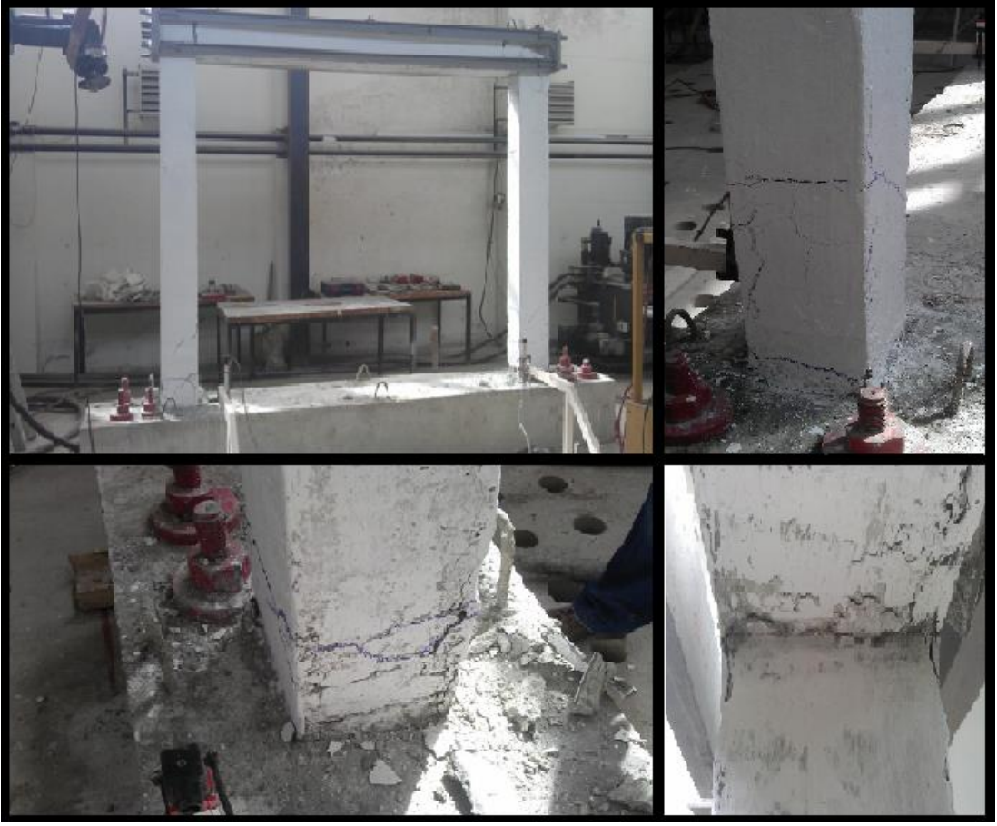
Şekil 3.6. PRCF-1 çerçevesinin deney sonundan görünümür
