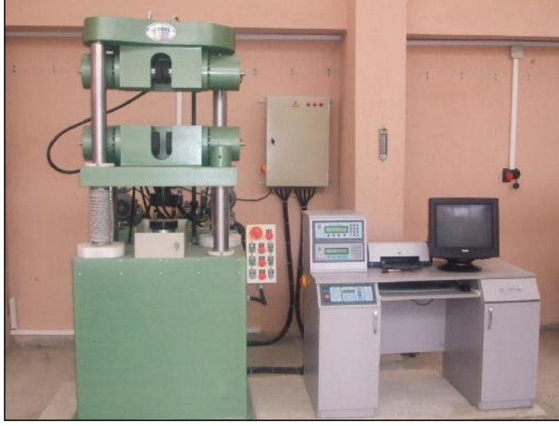
Şekil 2.2. Donatı çekme deneylerinin yapıldığı Üiversal deney aletinden bir görünüm
