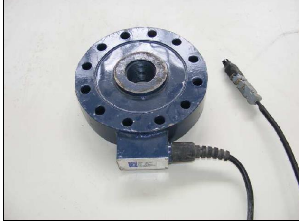
Şekil 2.21. Deney çerçevelerine uygulanan çevrimsel yük değerlerinin ölçülmesinde kullanılan 500kN kapasiteli CAS marka yassı tip yük hücresinden bir görünüm
