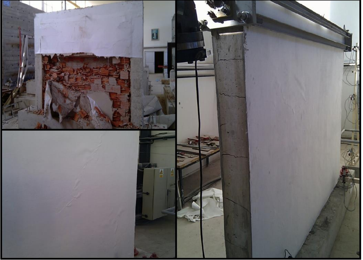
Şekil 3.24. RCF-2 çerçevesinin deney sonundan bazı görüntüleri
