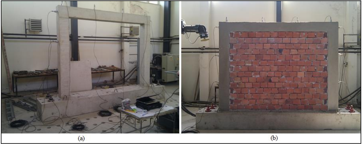
Şekil 2.25. Çevresel titreşimleri kullanan deneysel modal çözümleme yöntemiyle (a) dolgu duvarsız ve (b) tuğla dolgu duvarlı çerçevelerin dinamik özelliklerinin belirlenmesine ilişkin deney düzenekleri
