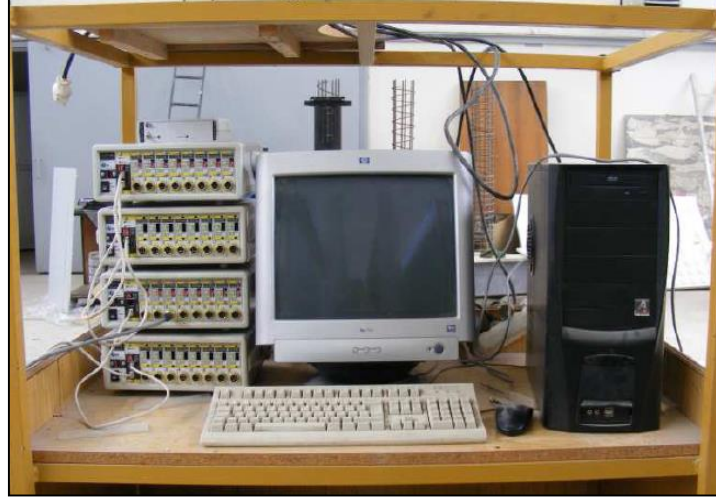
Şekil 2.23. Yük ve yerdeğiştirmeleri bilgisayara aktarmada kullanılan 32 kanallı veri toplama sisteminden bir görünüm
