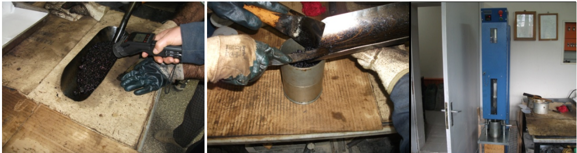
Şekil 26. Kalıplara dökülen karışımın sıkıştırılması
