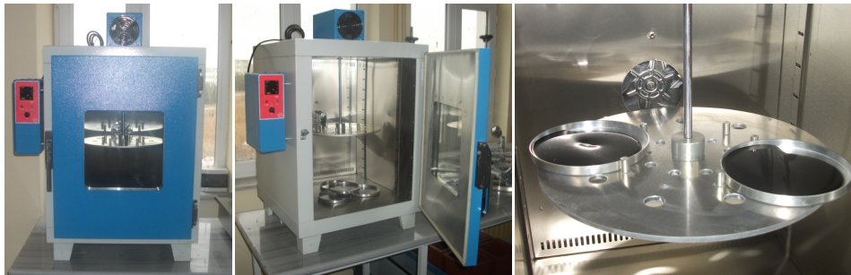
Şekil 8. İnce film halinde ısıtma deneyi
