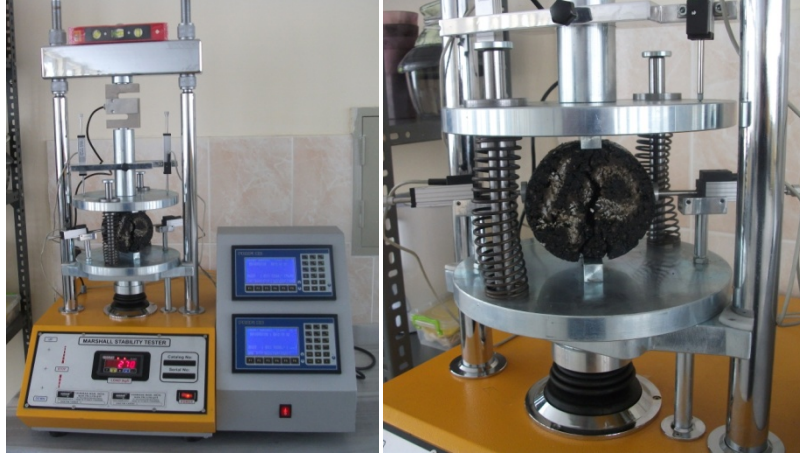
Şekil 28. Dolaylı çekme mukavemeti deneyi
