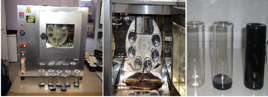
Şekil 9. Dönel ince film etüvü ve deney öncesi ve sonrasında şişelerin durumu
