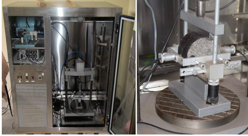
Şekil 31. ITSM deney düzeneği
