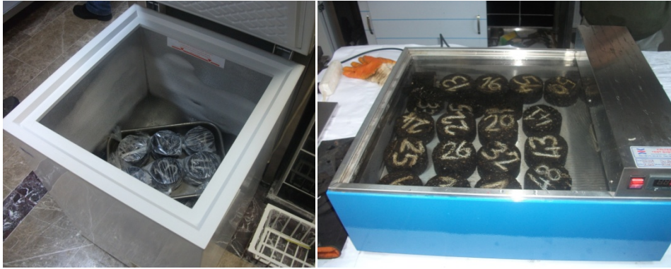
Şekil 30. Numunelerin -18^{\circ}\text{C} ve 60^{\circ}\text{C} 'de kür edilmeleri
