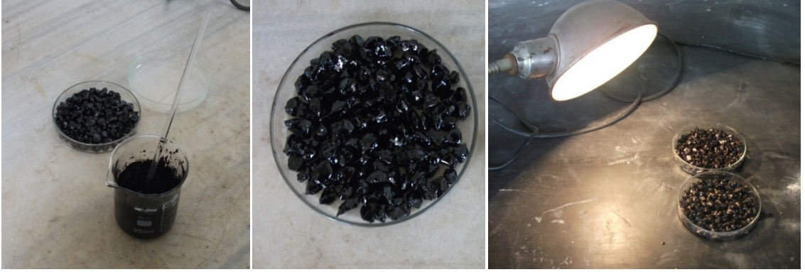
Şekil 32. Nicholson soyulma deneyinin yapılışı
