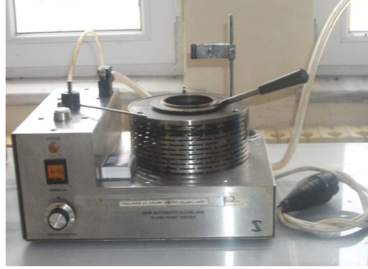
Şekil 7. Yarı-otomatik Cleveland parlama noktası deney aleti
