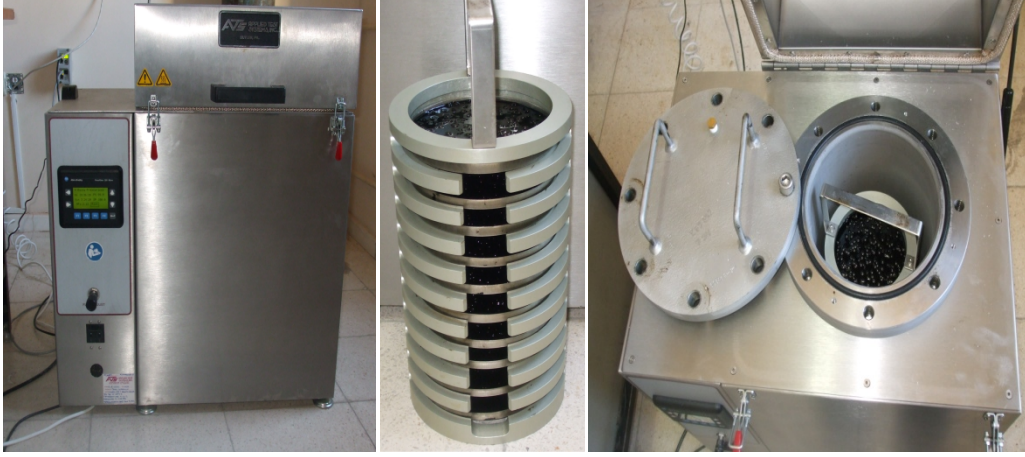
Şekil 10. PAV deney aleti
