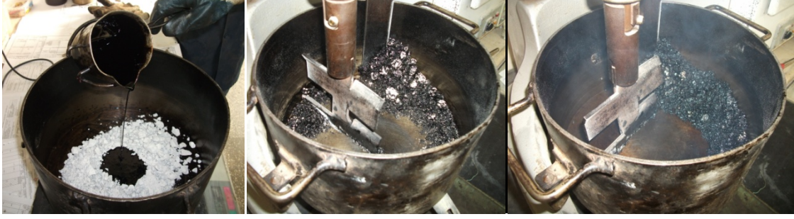
Şekil 25. Bitüm ve agreganın karıştırılması
