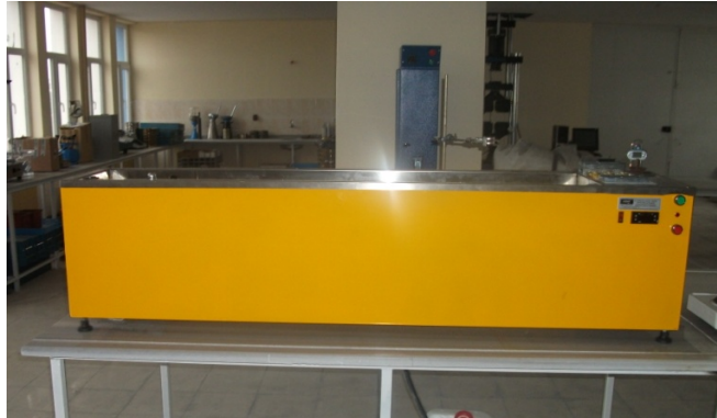
Şekil 6. Düktilite deney aleti
