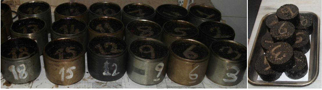
Şekil 44. Marshall briketlerinin hazırlanması
