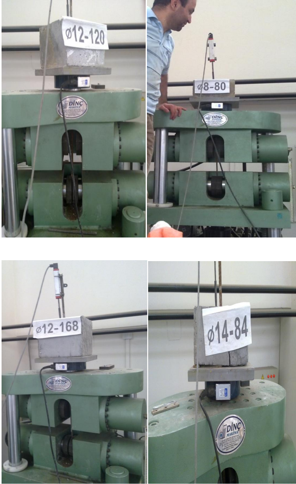
Şekil 40. Taşıyıcı hafif beton-donatı aderans deneyleri
