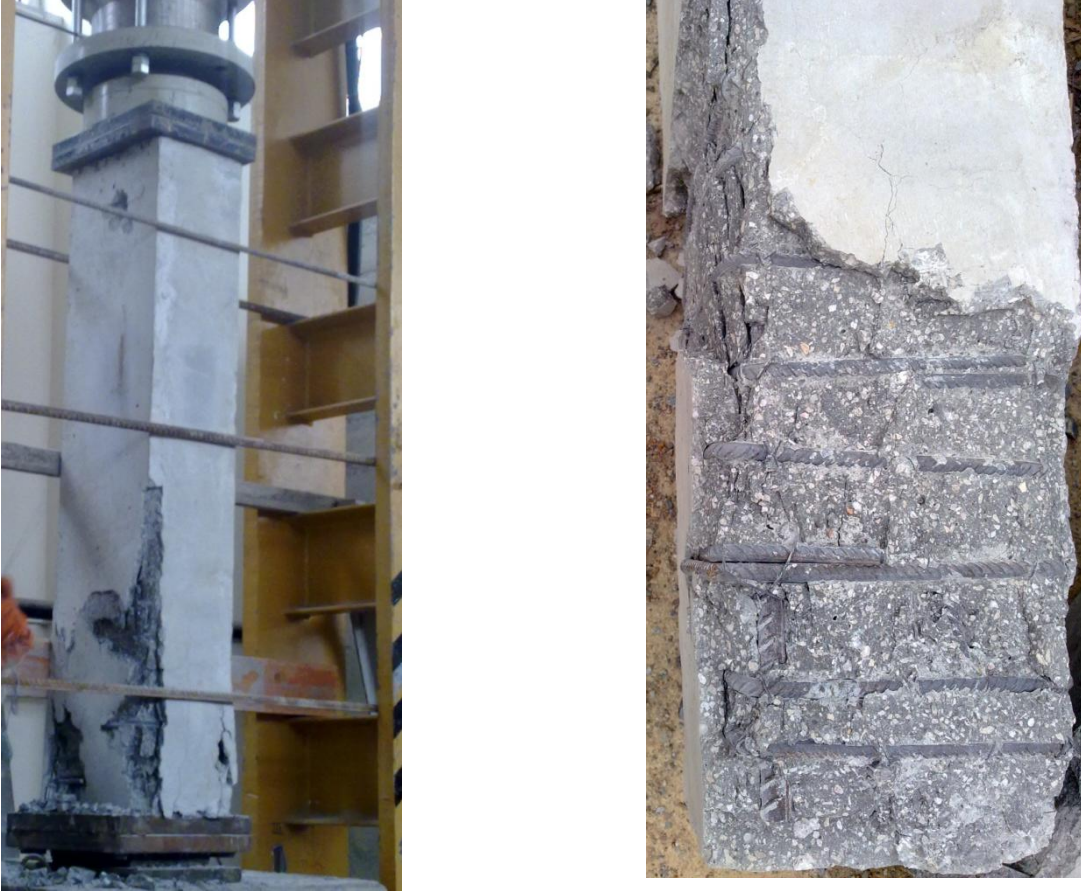
Şekil 58. Taşıyıcı hafif betonarme kolonlara ait tipik kırılma şekilleri
