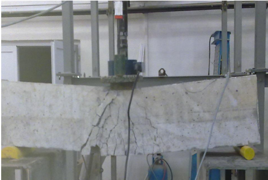
Şekil 53. Taşıyıcı hafif betonla üretilen kirişte göçme
