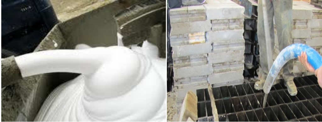
Şekil 16. Köpük beton üretimi
