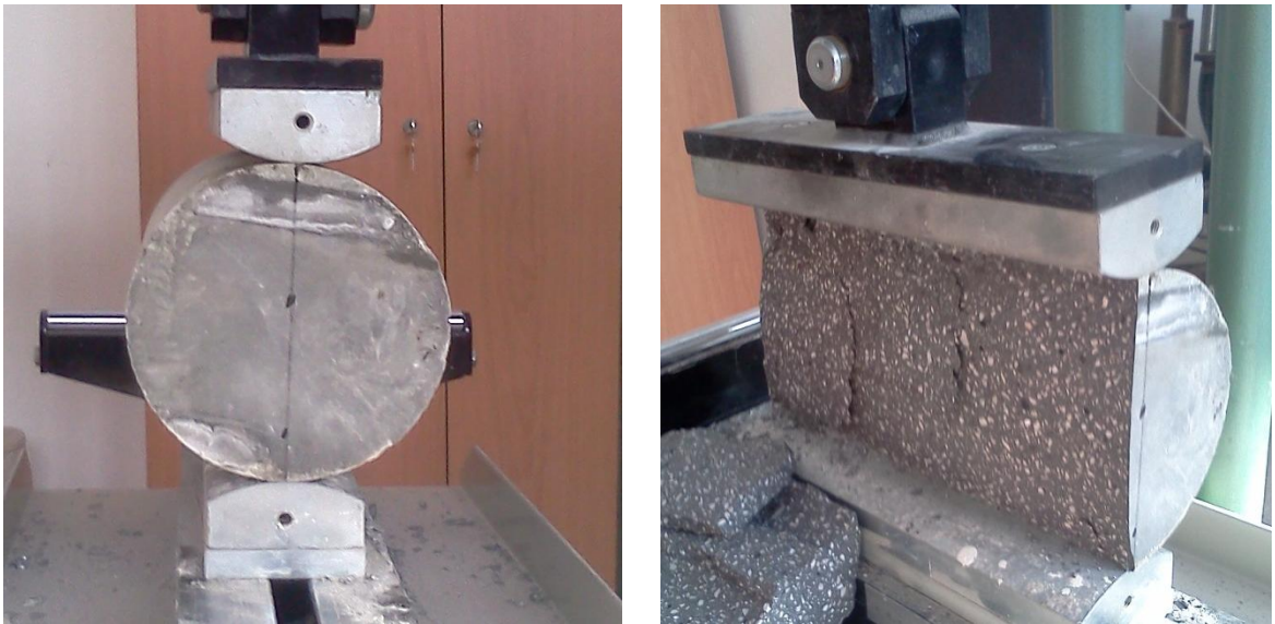
Şekil 36. Silindir yarma deneyi
