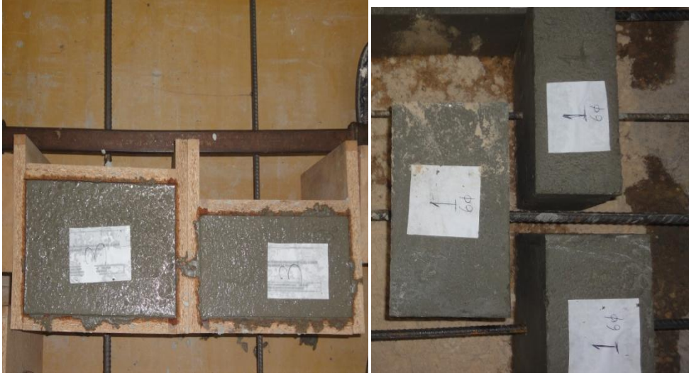
Şekil 37. Aderans numunelerinin hazırlanması
