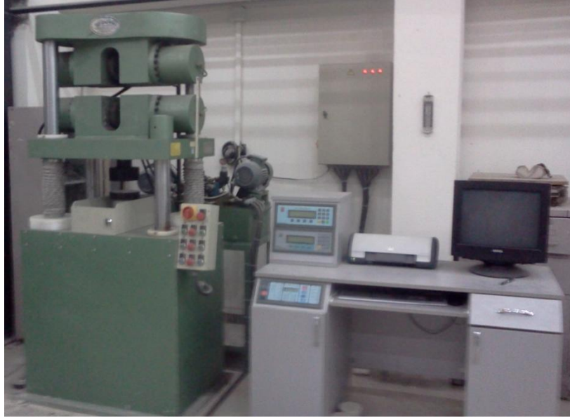
Şekil 30. 600 kN kapasiteli üniversal deney aleti
