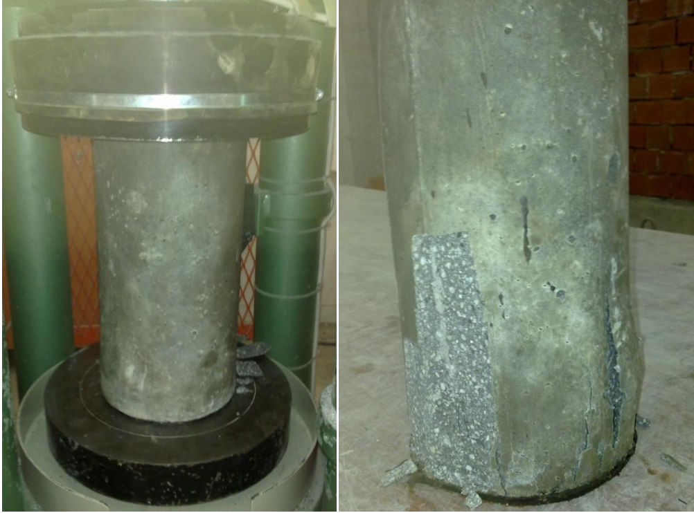
Şekil 33. Silindir numuneler üzerinde yapılan basınç deneyi
