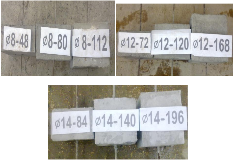
Şekil 38. Deneye hazırlanan taşıyıcı hafif beton aderans numuneleri
