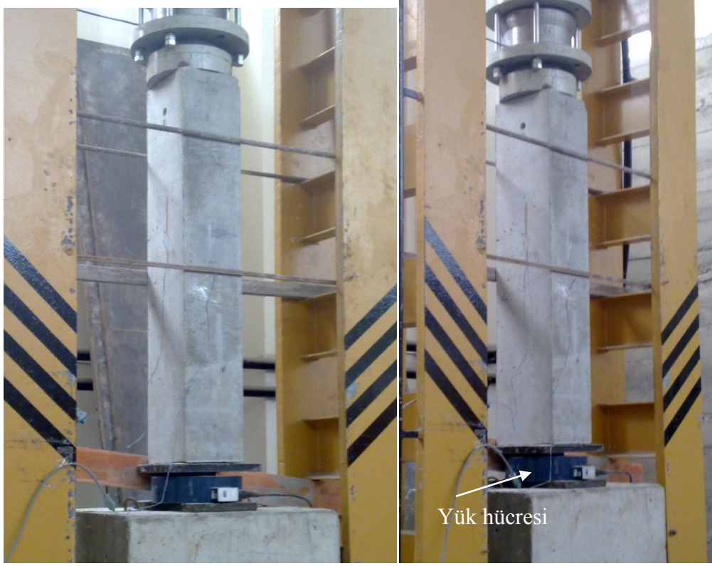
Şekil 57. Kolonların deneye hazırlanması
