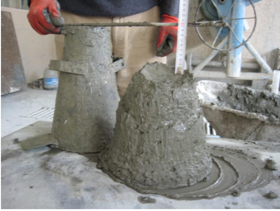
Şekil 32. Taze betonda çökme deneyi
