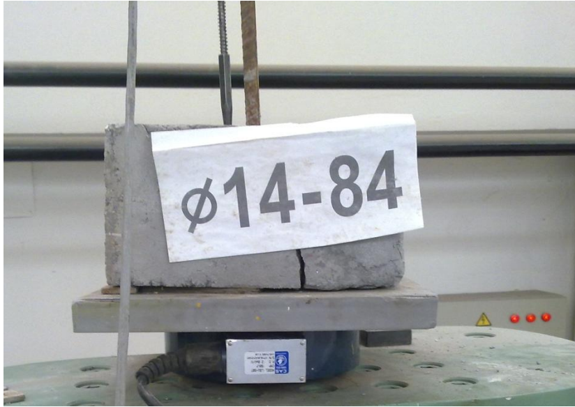
Şekil 44. Aderans deneyi sonunda betonun çatlamasıyla sıyrılan donatı
