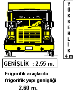
Şekil 2.14. Araç azami genişlik ve yüksekliği
