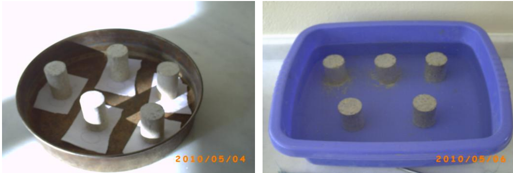
Şekil 3.30. 12 adet ıslanma-kurumu periyodundan birine ait görüntü
