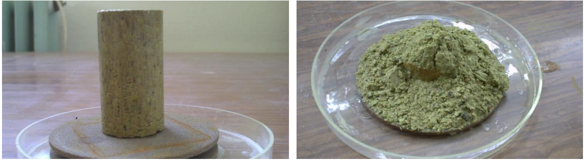
Şekil 2.9. Doğal malzemenin su içinde hacimsel bütünlüğünü kaybetmesi
