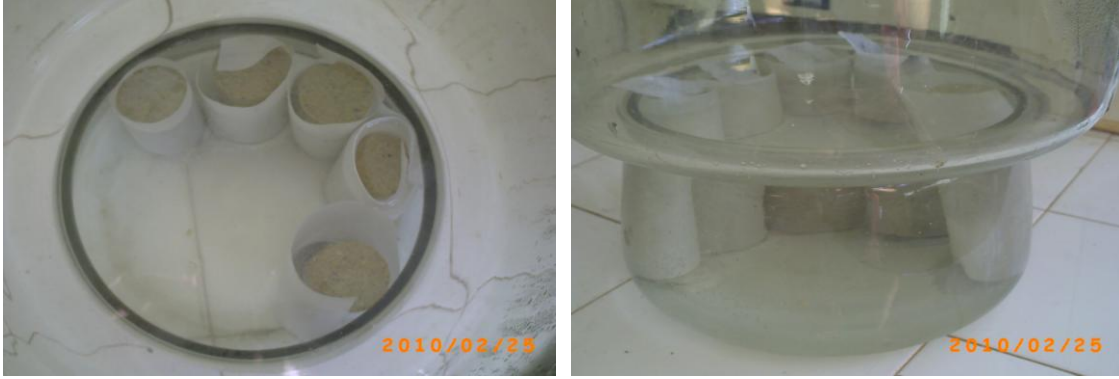
Şekil 3.33. Durabilite deneyi için deney numunelerinin su içinde bırakılması
