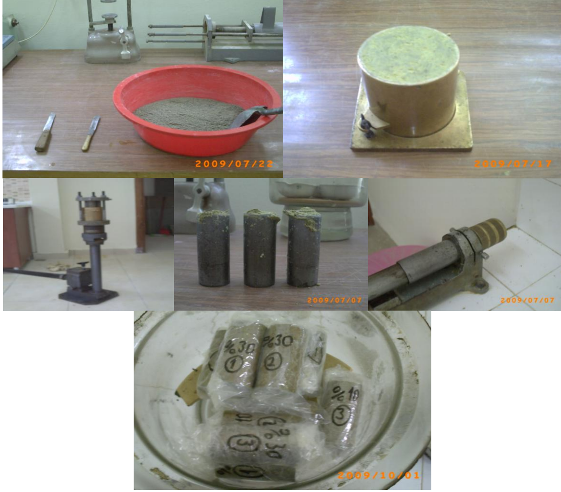
Şekil 2.1. Serbest basınç deneyi için numunelerinin hazırlanması ve saklanması
