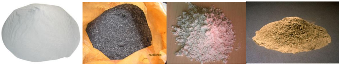
Şekil 1.16. Yapay puzolanlar (silis dumanı, pirinç kabuğu külü, yüksek fırın cürufu ve uçucu kül)
