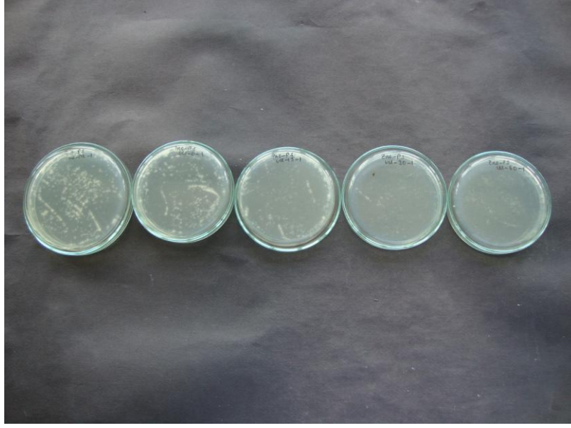
Şekil 104. Başlangıç mikroorganizma sayısı 1 \times 10^6 (CFU/mL) olan A. niger 'in 0-60 dakika ZnO-PS/UV sistemi sonrasında ekim yapılan petrileri
